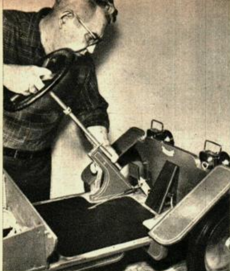
La colonne de direction est maintenue par un support en contreplaqué et un arc-boutant métallique au châssis. Une cornière métallique, vissée en haut du support, sert de palier.
