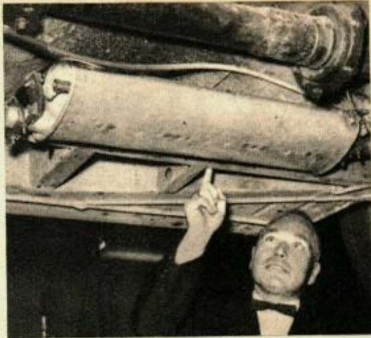
Le post-brûleur remplace le pot d'échappement habituel sous la voiture, mais il est accompagné de soupapes, fils, etc. Le prix dépassera certainement 500 F.
