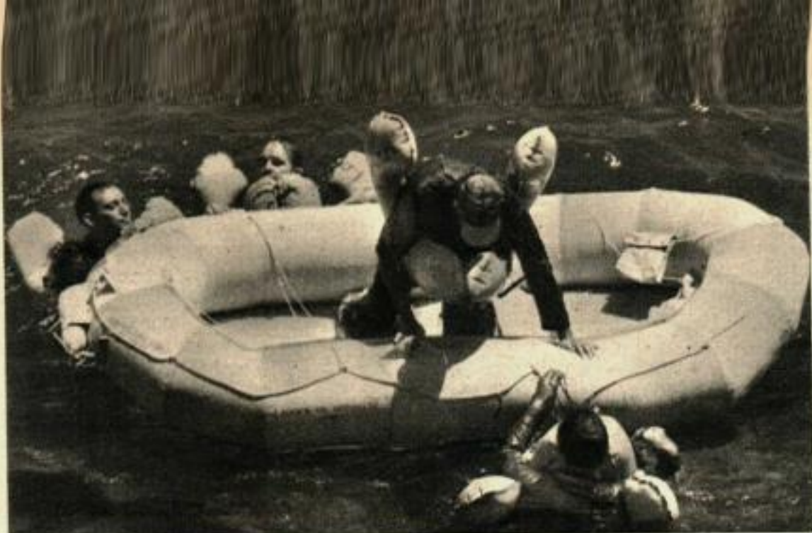
UNE EQUIPE D'UN CANOT A SIX PLACES monte à bord. Les cordes fixées sur le bord ovale permettent aux survivants de s'accrocher et de grimper dans le canot. Les pagaies et la toile protectrice utilisée comme voile se trouvent dans la trousse de survie, au fond du canot. La bouteille de gaz carbonique qui gonfla le rebord se trouve sur la gauche du canot.
