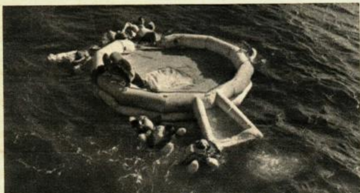
UNE EQUIPE D'UN CANOT A VINGT PLACES fait des efforts pour grimper à bord. Des plates-formes d'embarquement se trouvent de chaque côté du canot. La trousse de survie et la coupole se trouvent au centre. Le double bord, gonflé simultanément, peut être protégé contre une double crevaillon grâce à un crampon égalisateur.
