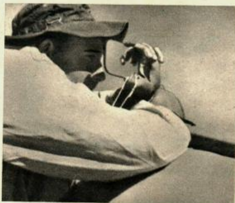
UN MIROIR DE SIGNALISATION est essayé par un élève à bord d'un canot à vingt places. La réflexion du soleil peut être dirigée sur n'importe quel but grâce au trou central, et les messages peuvent aussi être envoyés dans la direction voulue.
