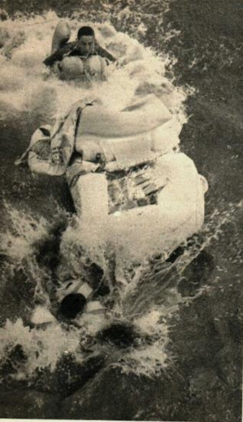
VOICI UN CANOT pendant l'opération de gonflement. On tire d'abord sur la corde de gonflement, puis on jette le canot par-dessus bord, et les survivants sautent immédiatement après lui.
