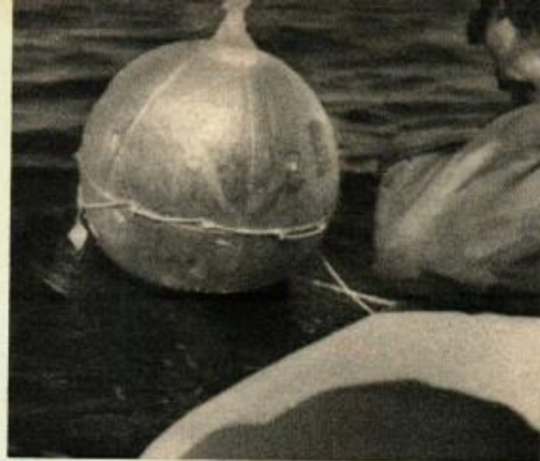
LA DISTILLERIE SOLAIRE distille l'eau de mer. Cette dernière est versée par en haut, et se retrouve filtrée au fond en tant qu'eau potable. L'élève (à droite) a le mal de mer.
