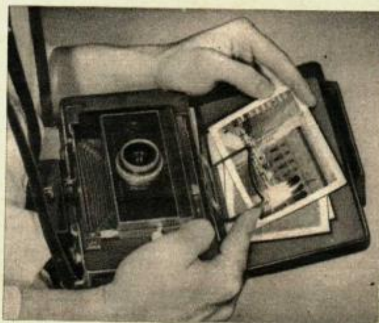
Le couvercle du boîtier du « Polaroid 100 » porte un volet qui permet de ranger les tirages pendant une série de prises de vues. Mais il y a toujours la vidange des négatifs à faire comme devant.
