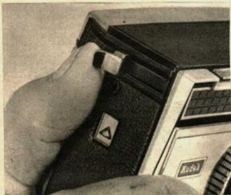
TOUS LES « INSTAMATIC » sont équipés d'un dérouleur rapide de pellicule avec un levier qui fait avancer la pellicule pour la prise de vue suivante et arme automatiquement en même temps l'obturateur.
