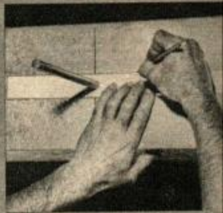
5. — Enfiler le gabarit sur l'axe et tracer soigneusement le contour.
