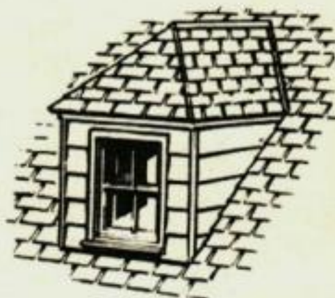
MANSARDE A TOIT EN CROUPE
