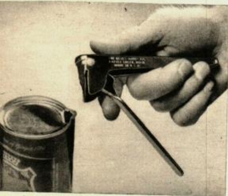
CET OUVRE-BOITE forme un bec à verser en même temps qu'il perce le couvercle d'une boîte de conserve. Il est chromé et inoxydable. Pour s'en servir, presser le bouton de la lame vers le bas, puis tirer le levier vers le haut pour former le bec. La boîte sert alors à verser le liquide sans en perdre sur le bord.
