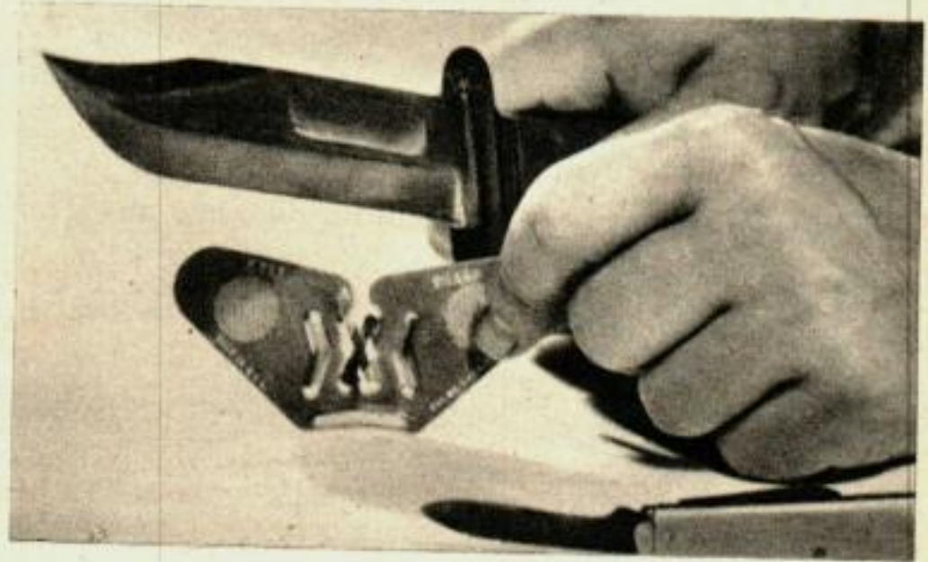
CET OUTIL A AIGUISER donne le fil du rasoir à toute lame. Tenir l'outil dans la main gauche, la fente tournée vers le haut, le placer sur une planche à couper, placer la lame dans la fente et la tirer vers vous. Répéter plusieurs fois.
