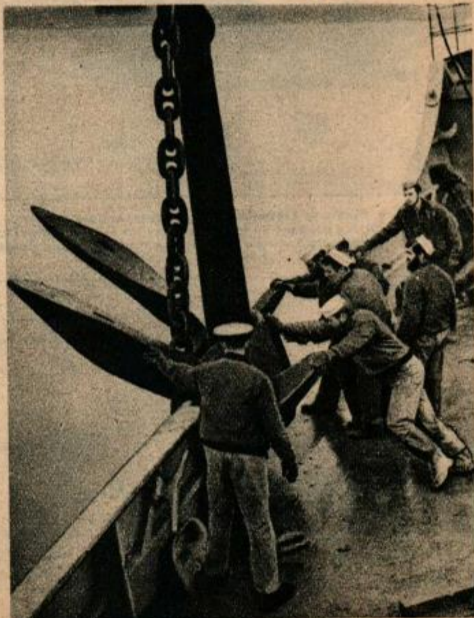
Le navire se penche sur le côté lorsqu'une bouée d'amarrage de 20 tonnes est soulevée par le mât de charge et descendue sur l'un des côtés du navire, dans un fjord de Groenland. Ci-dessous, mise en place d'une ancre de 10 tonnes destinée à ancrer une bouée d'amarrage. Lorsque l'ancre touche le fond, le câble servant à la descente est remonté sur le pont du navire.
