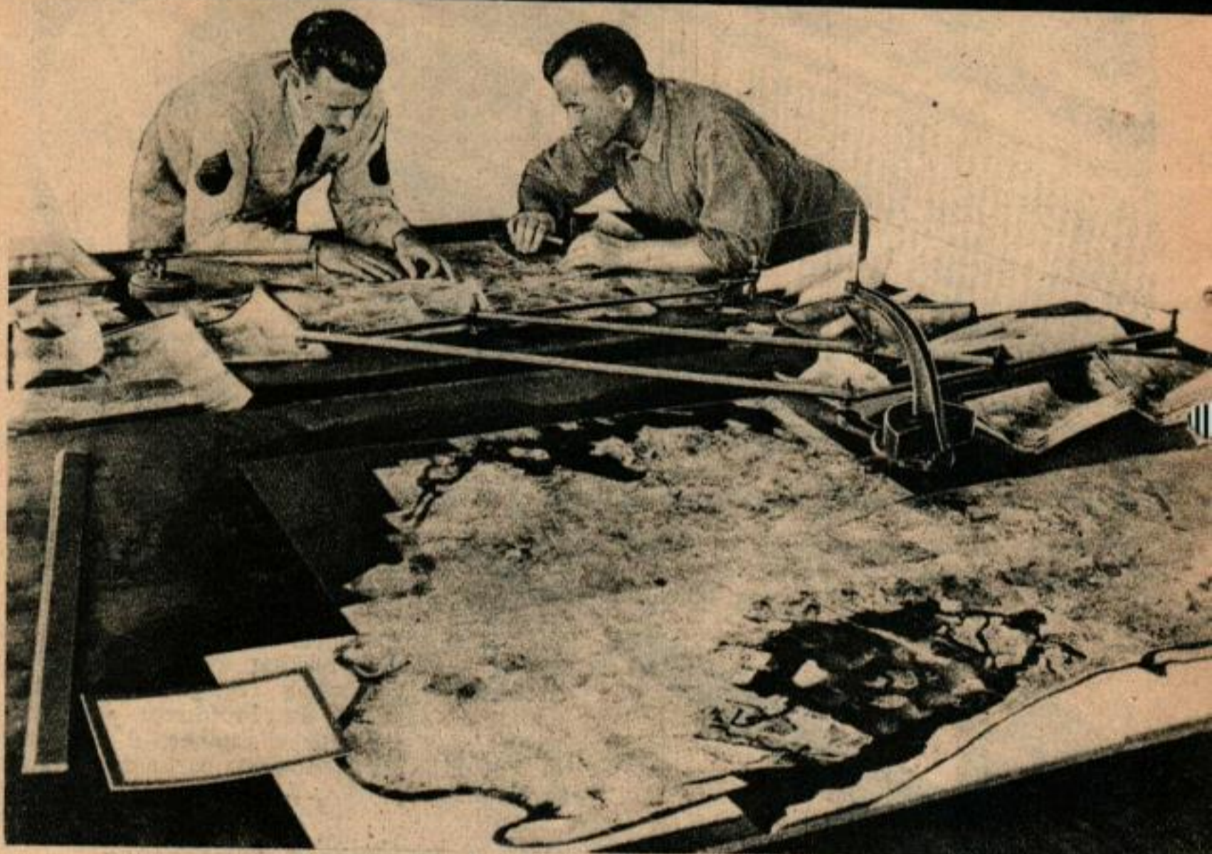
En construisant une mosaïque à partir des photos aériennes, ces modernes traceurs de cartes économisent des centaines d'heures de travail.
