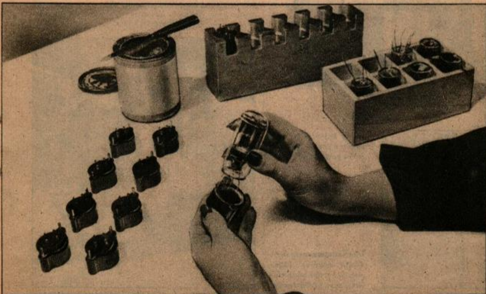
Les cristaux synthétiques, enfermés dans leur gaine hermétique, sont montés sur des bases à broches avant d'être utilisés comme sélecteurs sur les circuits à longue distance.
