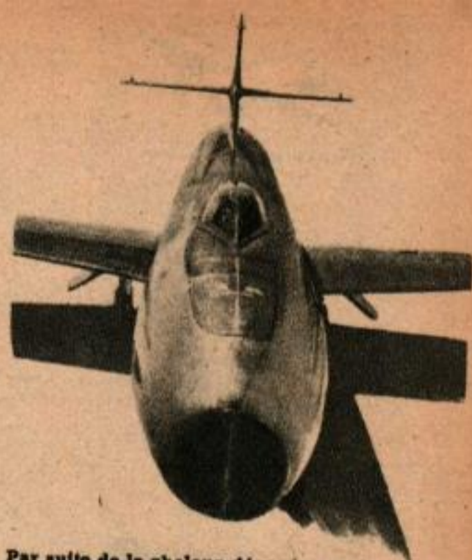
Par suite de la chaleur dégagée par le frottement de l'air, le toit en matière plastique a été remplacé par un toit métallique muni de vitres épaisses.
