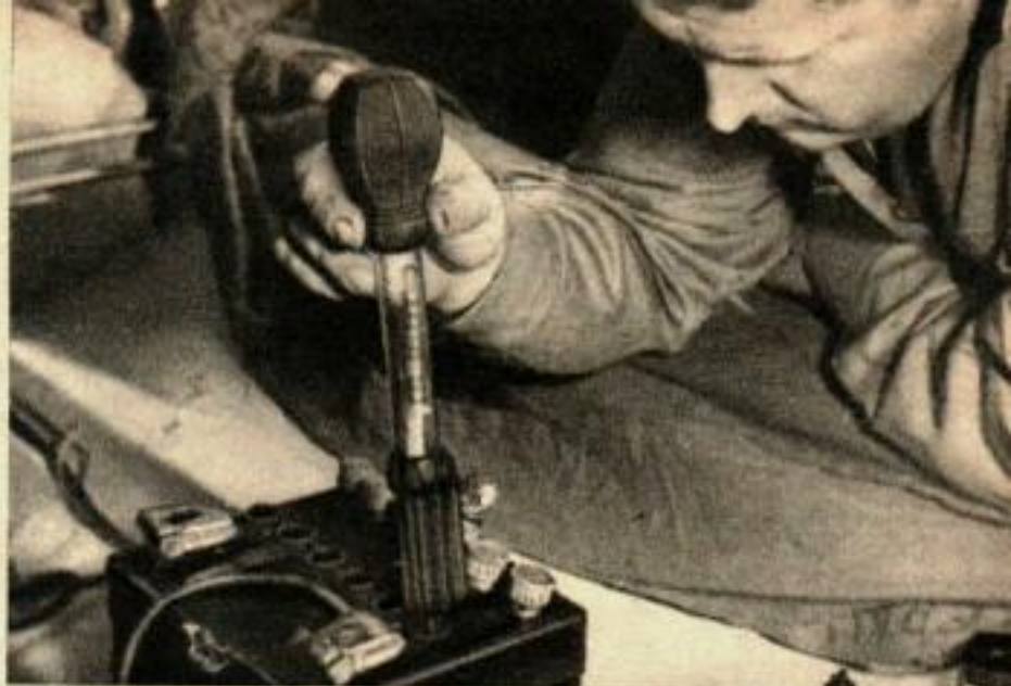
La vérification de la batterie par utilisation d'un hydromètre est effectuée en retirant un peu d'électrolyte de chaque élément.
