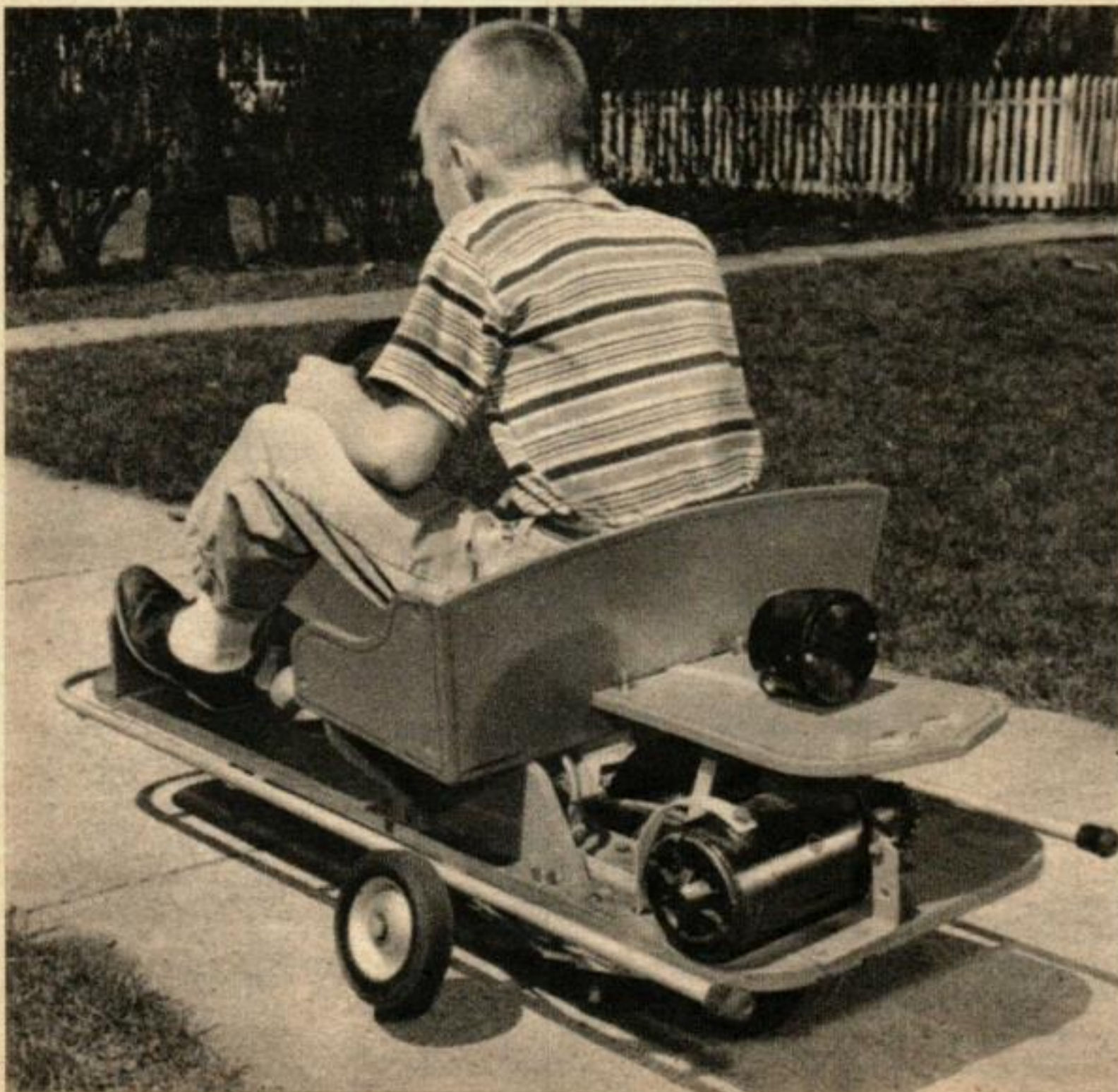
La chaîne et les pignons donnent un entraînement direct de la roue motrice par le moteur. Le mou de la chaîne ne doit pas dépasser 12 mm. Remarquer les positions des lames de tension et de masse.
