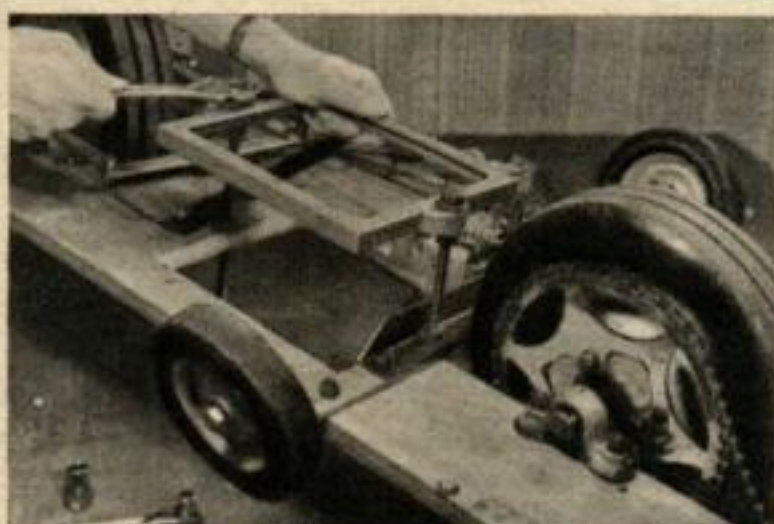
La partie basse du berceau de batterie est maintenue en position par des écrous d'arrêt. Bien serrer ces écrous.
