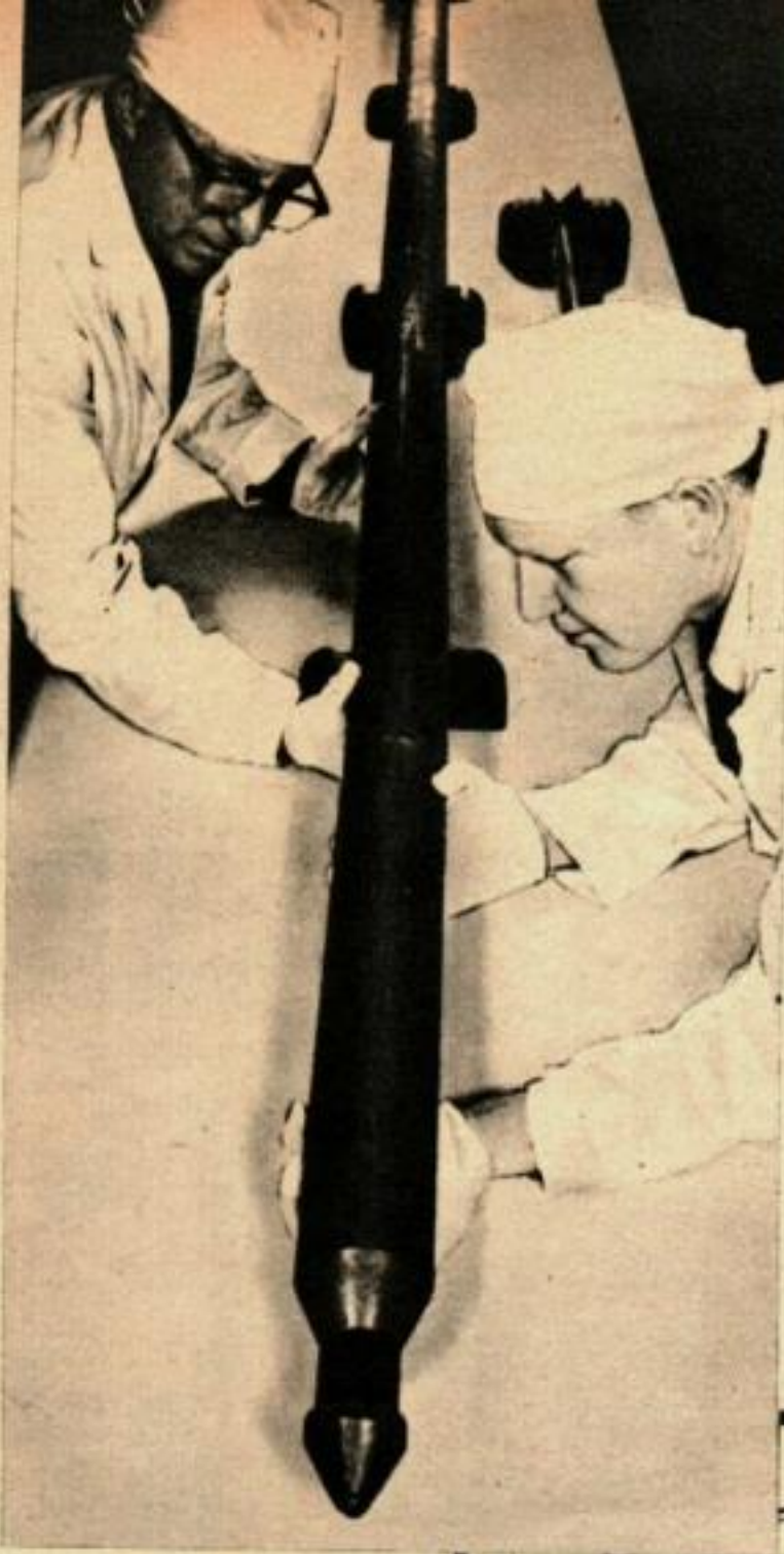
Barre d'uranium et de thorium, entourée de graphite, élément actif d'un réacteur refroidi aux gaz, mis au point par « General Dynamics » l'un des 800 éléments de 4 m qui formeront la pile.
