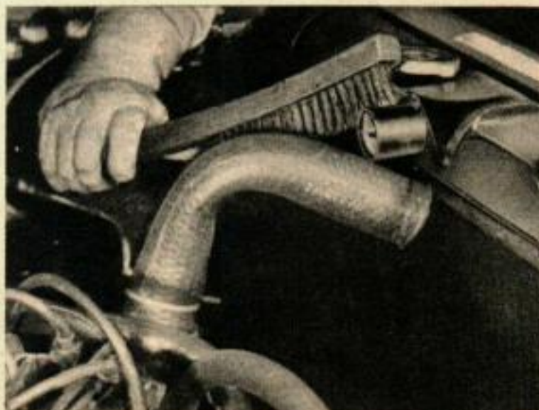
Nettoyez soigneusement les raccordements avant d'y fixer un nouveau tuyau. Employez à cet effet une brosse métallique et enlevez toute trace de rouille, puis nettoyez les raccords avec un chiffon propre.
