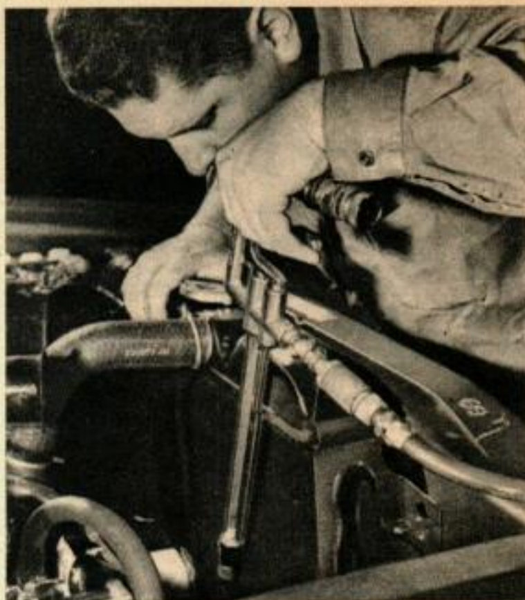
Un jet d'air dirigé à travers le radiateur depuis l'arrière dégagera les insectes, débris et poussières accumulés dans les rayons du radiateur. Enlevez les gros insectes à l'aide d'une brosse douce.
