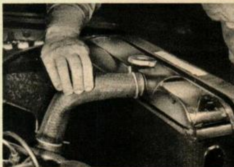
Nettoyez soigneusement les raccordements avant d'y fixer un nouveau tuyau. Employez à cet effet une brosse métallique et enlevez toute trace de rouille, puis nettoyez les raccords avec un chiffon propre.
