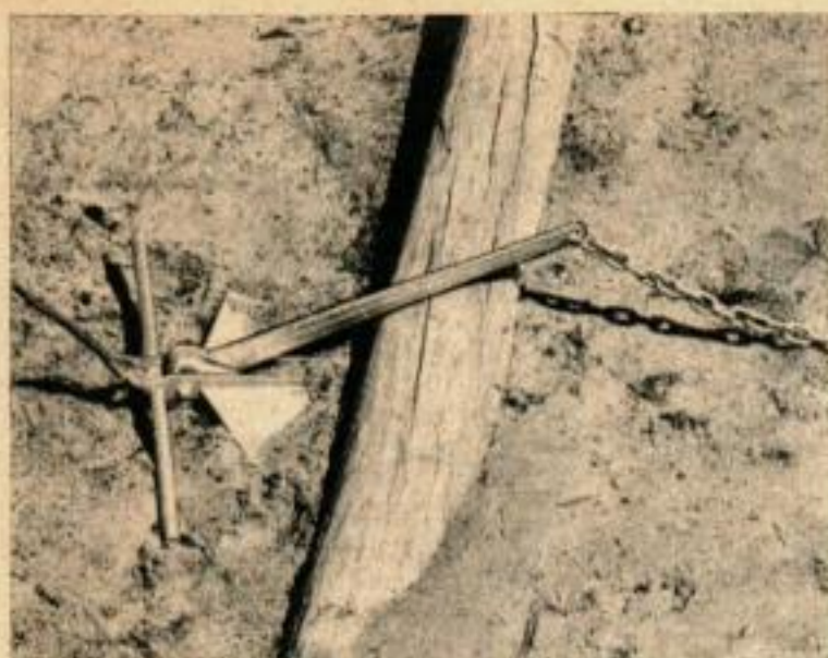
Un câble attaché à la couronne permettra souvent de libérer une ancre prise dans un obstacle et qui ne peut être dégagée par l'inversion du sens de la traction.
