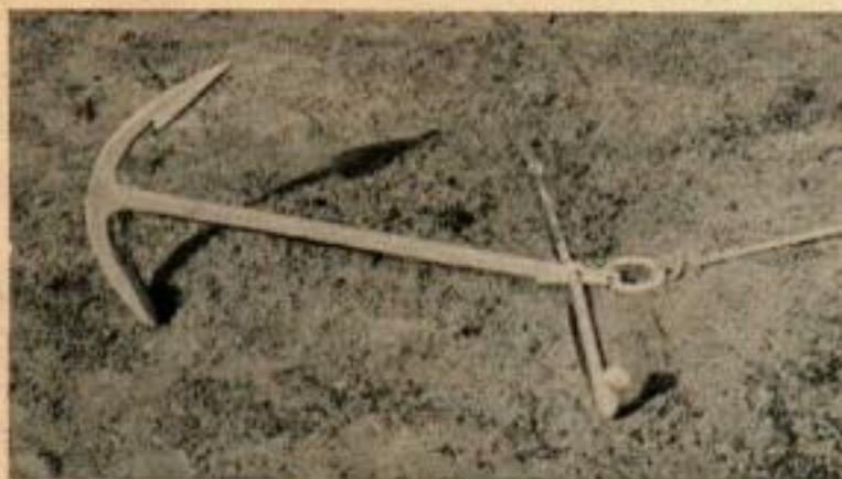
Le Yachtsman est doté d'un jas, en arrivant sur le fond il est prêt à s'enfoncer rapidement grâce à une patte à angle pointu.
