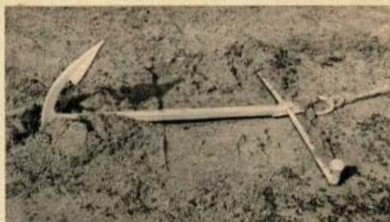
La projection d'une patte constitue un inconvénient du yachtsman, car il peut arriver que la corde de l'ancre s'y accroche.
