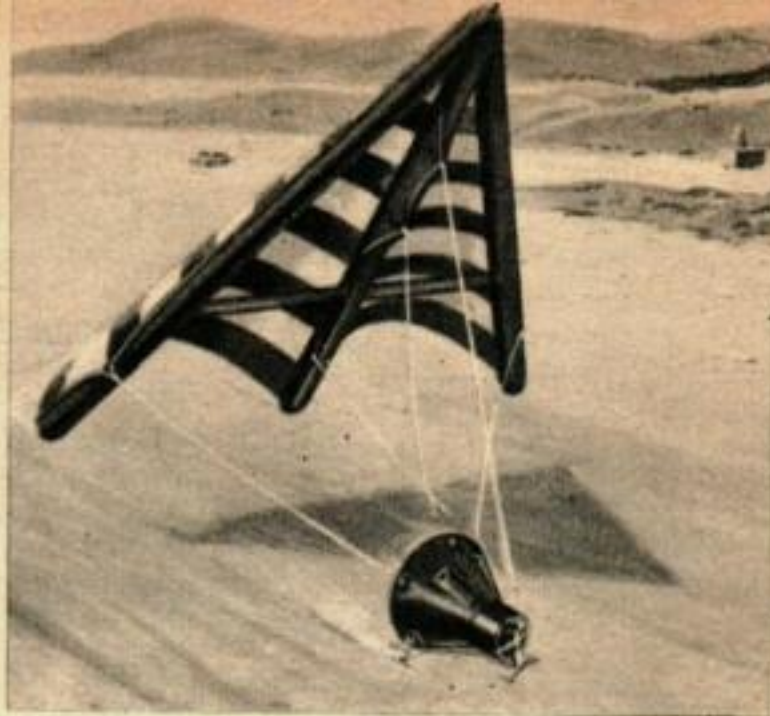
Un paraglisser s'ouvrira à une altitude de 20 000 m et permettra à la capsule Gemini d'effectuer un atterrissage doux à un endroit choisi à l'avance ; mais les deux premiers atterrissages de la capsule se feront encore avec l'aide d'un parachute.
