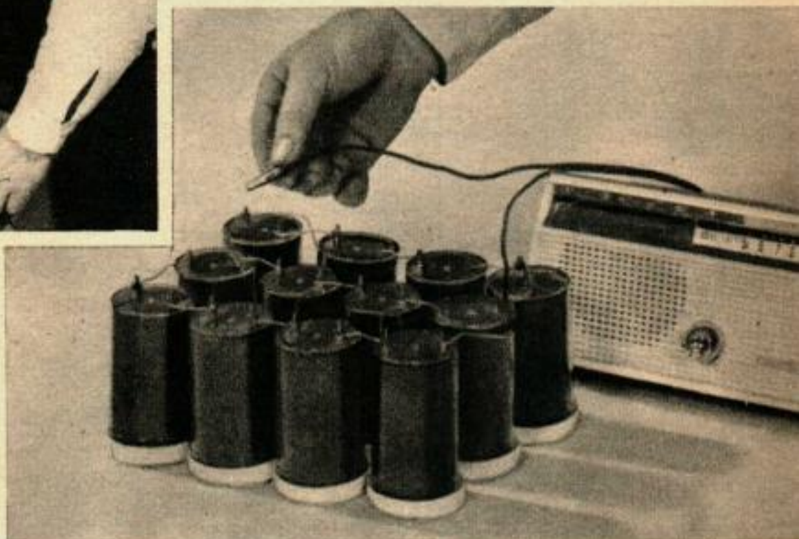
La pile à hydrogène - oxygène (ci-dessus) est construite par Pratt et Whitney. A sa droite, deux piles : la pile à « bactéries » (à gauche), et la pile à hydrogène (à droite).
