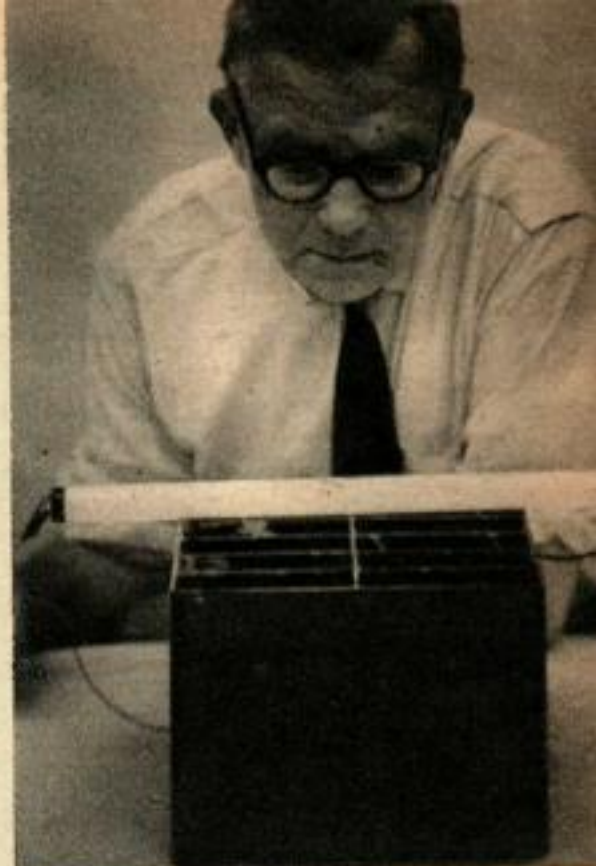
La pile de « Bactéries » ressemble beaucoup à l'accumulateur classique à base de plomb et d'acide. Dans le présent cas, elle est employée pour l'allumage d'une lampe fluorescente ordinaire. Les éléments n'ont pas besoin d'être rechargés, pour assurer son fonctionnement, il suffit d'y ajouter de l'eau et une substance nutritive.
