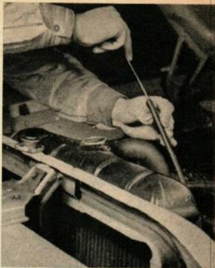
Sur les voitures d'aujourd'hui, le tube de trop-plein est en caoutchouc et peut être facilement retiré pour des raisons de nettoyage. Les voitures plus anciennes sont équipées de tubes de trop-plein métalliques.
