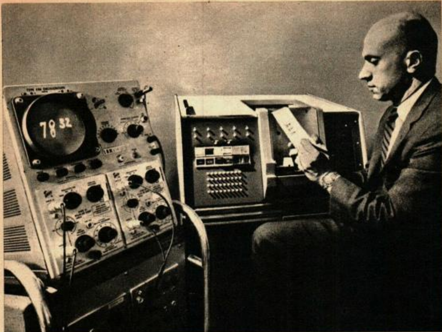
La lectrice expérimentale de manuscrits ? Une carte perforée sur laquelle des chiffres sont inscrits, est introduite dans l'appareil. A gauche, un oscilloscope qui contrôle et reproduit optiquement les chiffres inscrits.
