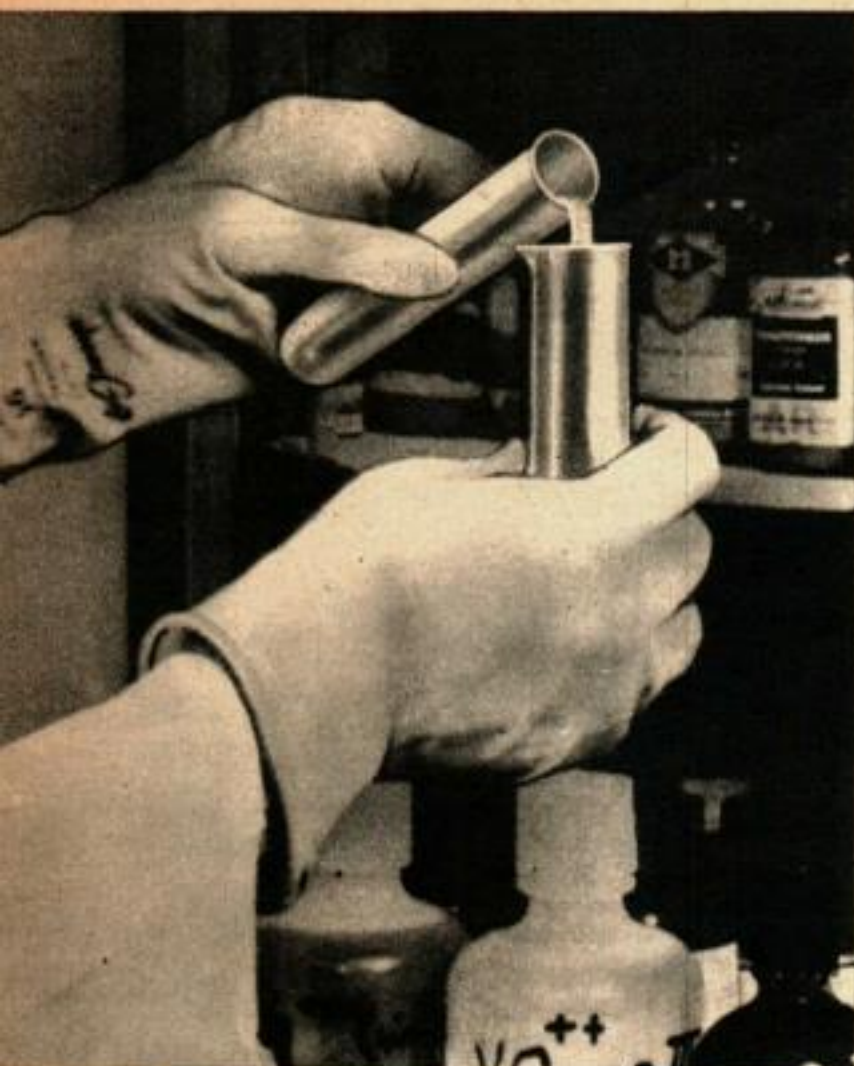
Lorsqu'on soupçonne un empoisonnement, un spécimen de cheveu ou d'ongle de la victime est introduit dans le réacteur. Le poison est ensuite isolé par séparation radiochimique.
