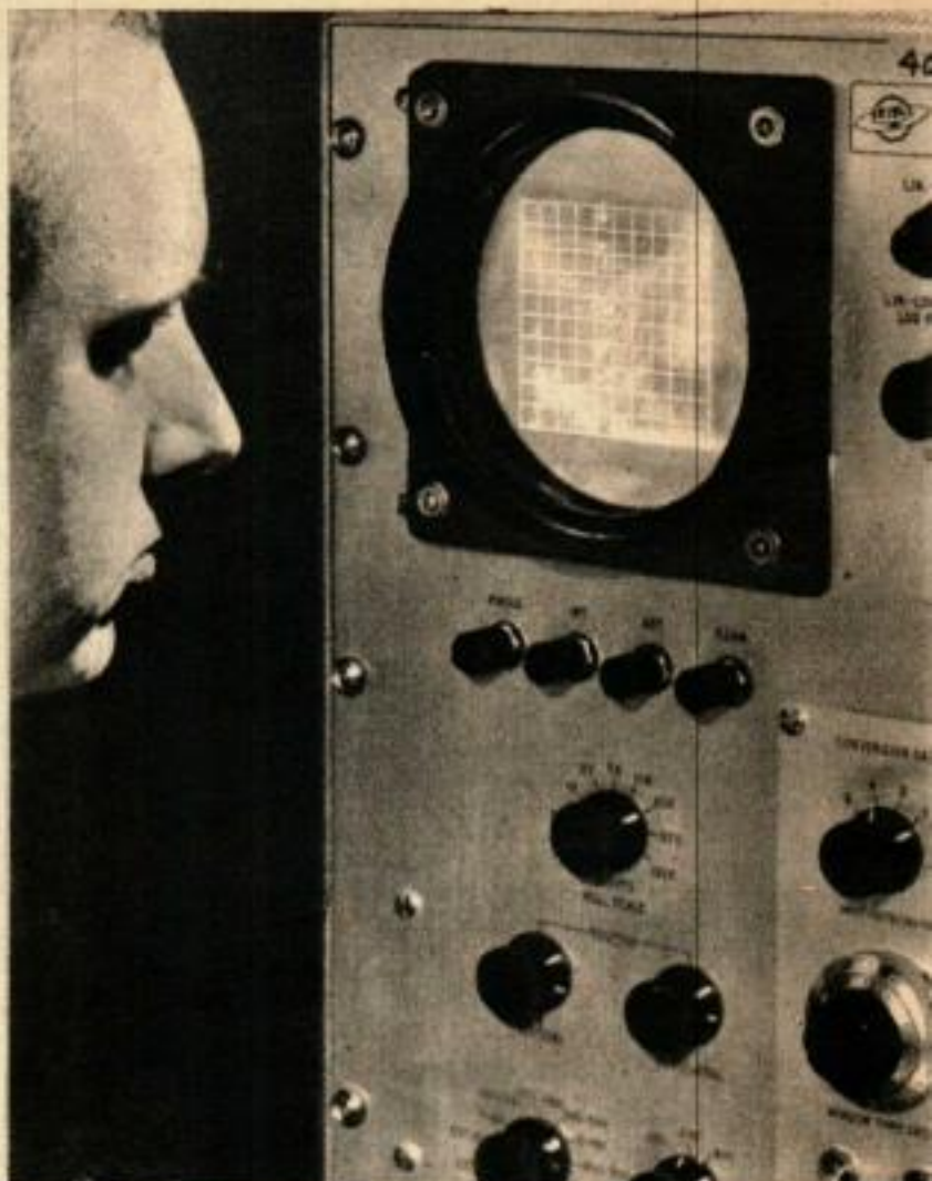
Après bombardement dans un réacteur, l'identification des oligo-éléments contenus dans les spécimens examinés sont obtenus par analyse à l'oscilloscope.
