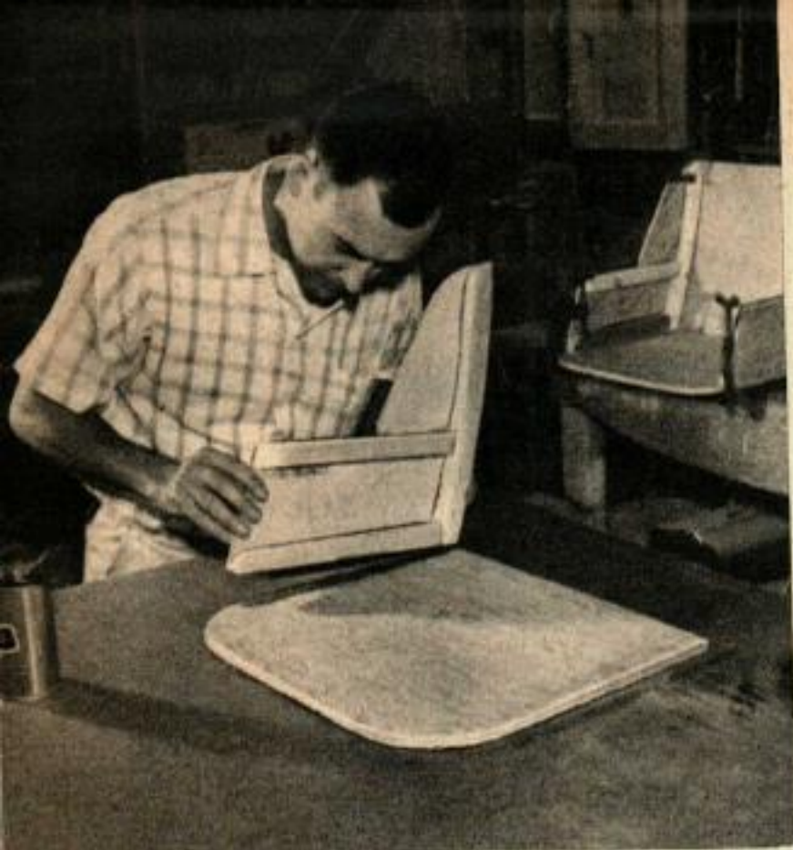
Les sièges baquet sont encadrés par des lattes légères qui sont des moitiés de planche de 25x75 découpées à la scie circulaire.
