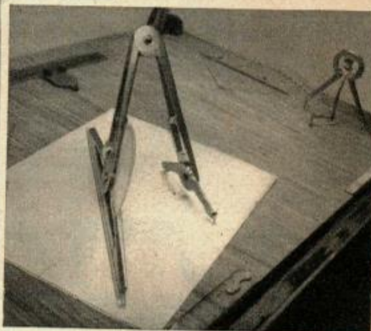
En utilisant son PDM, Bowen fait un dessin en perspective d'un cube traversé par un cylindre en partant d'un dessin portant simplement un carré contenant un cercle.
