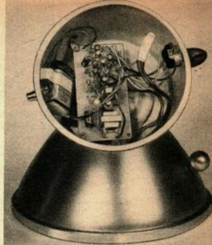
Vue du dessous de l'amplificateur montrant l'emplacement des pièces dans le socle du projecteur.
