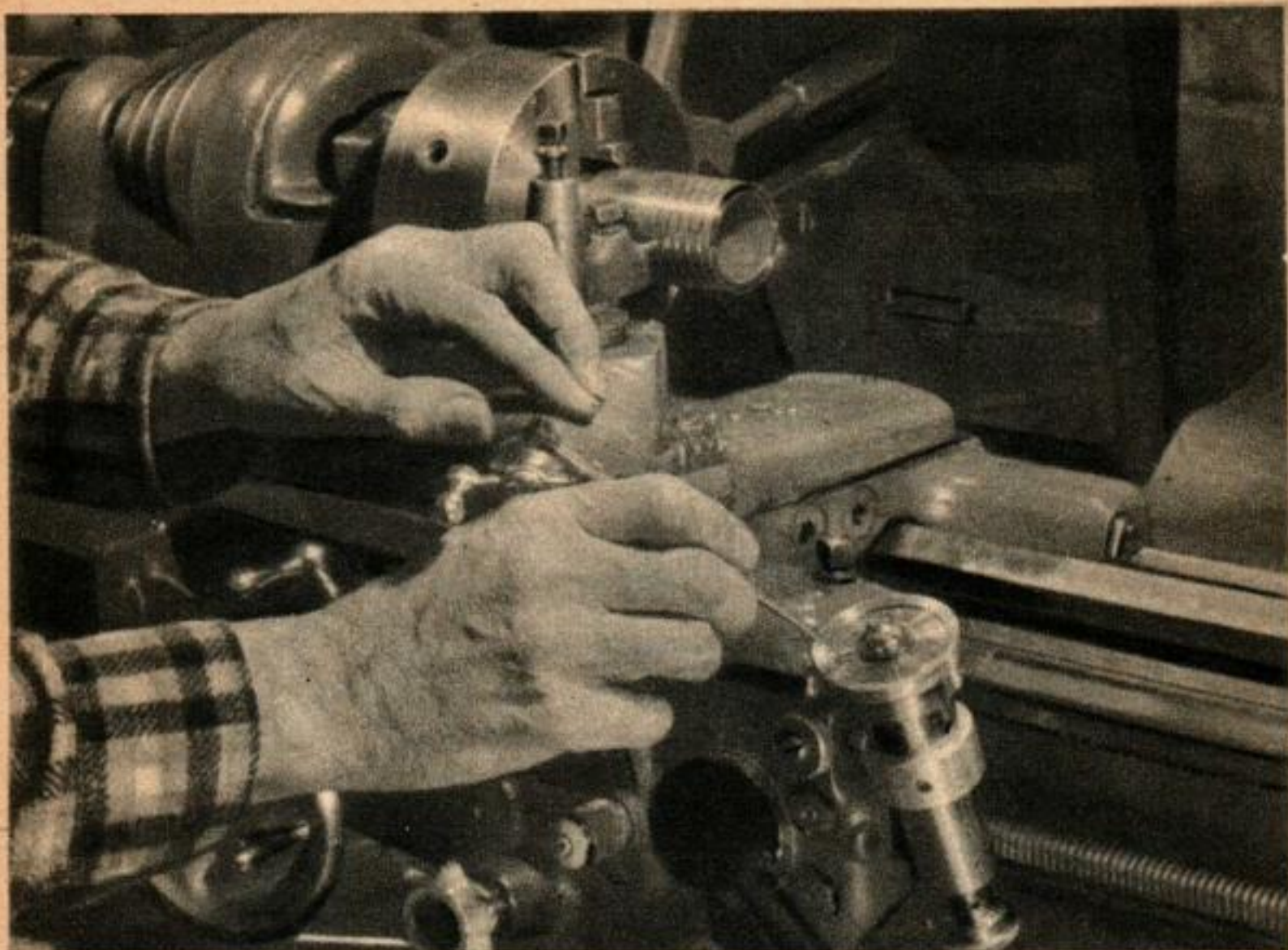
Les disques limiteurs peuvent être réglés avec la pointe d'un traceur : ici, pour usiner des rainures également espacées sur un tube en laiton.
