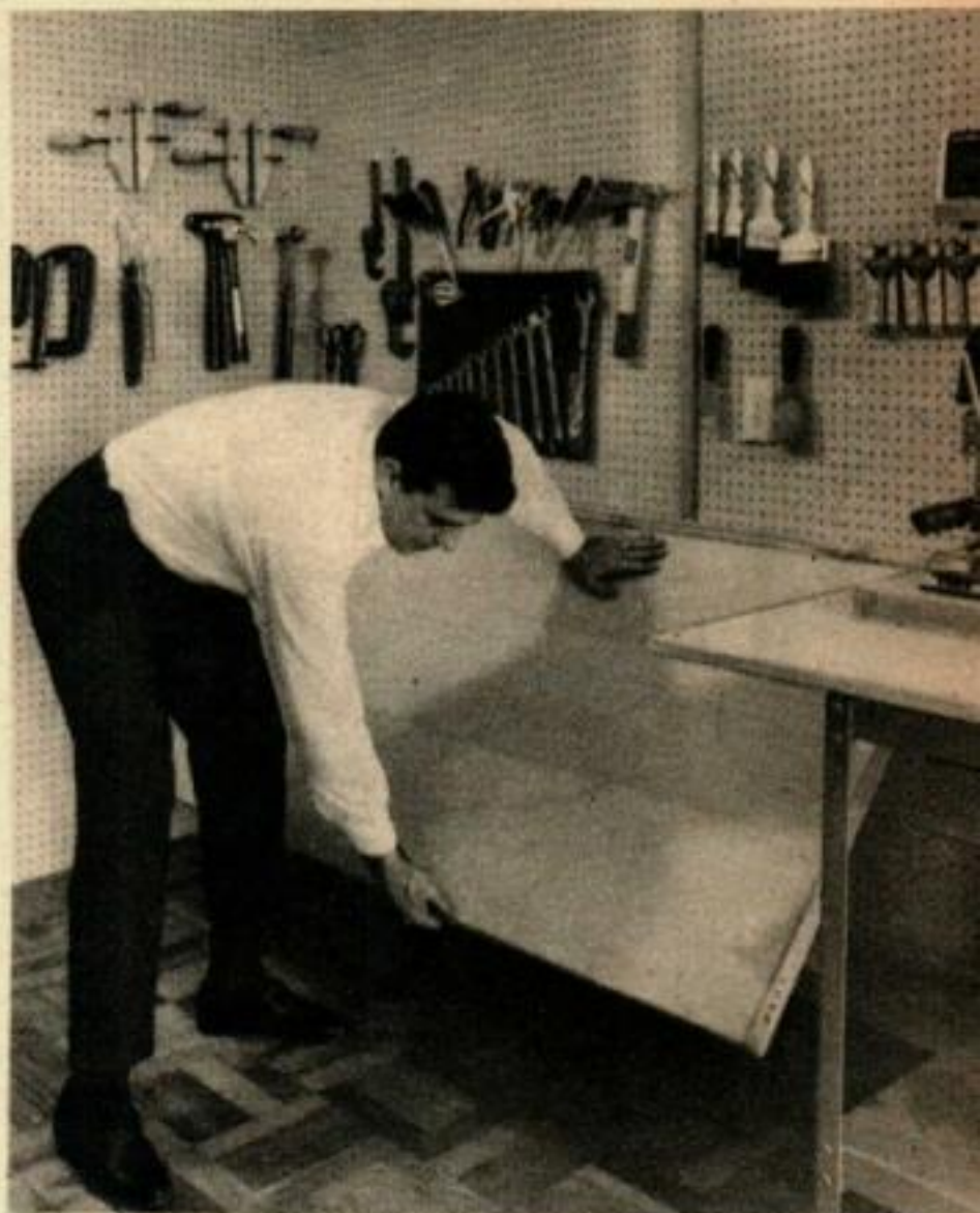
La caractéristique de cet atelier est un banc pliant solide, de chaque côté d'une scie à bras radial.
