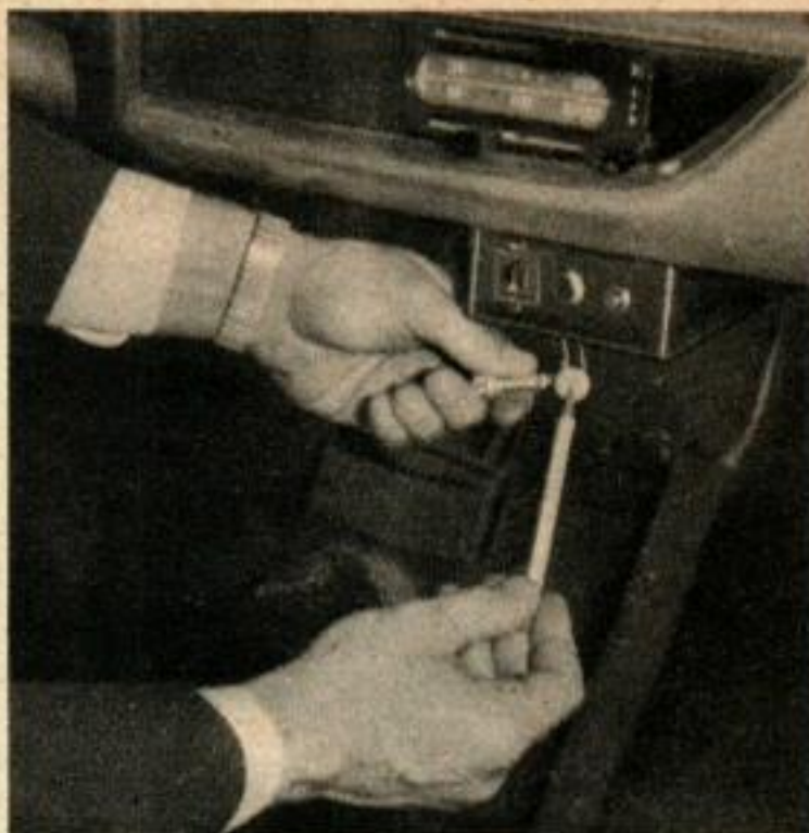
LE THERMOSTAT D'INTERIEUR est monté derrière le tableau de bord, en air frais hors du souffle du chauffage de la voiture.
