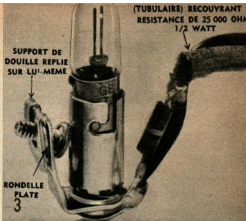
Cet assemblage, détaillé sur la page ci-contre, est ajusté à l'intérieur de la boîte à pellicule. Remarquez le pliage du support.
