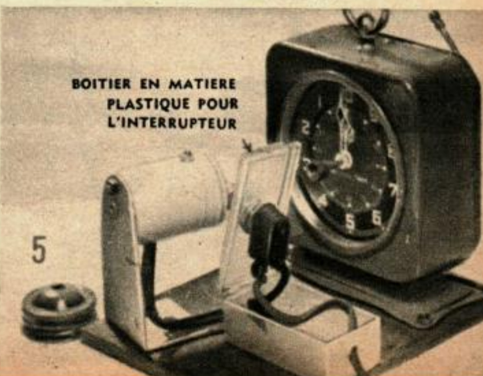
Ci-dessus, l'élément complet monté sur son support est prêt pour l'installation sur le socle. Ci-dessous, le contact à presse-bouton est monté dans le boîtier en matière plastique comme indiqué.
