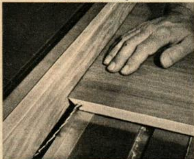
5. ASSEMBLAGE DU PLACARD , avec l'un des jointages à onglets serré à la presse et un deuxième jointage en cours de montage. Remarquez spécialement la languette dans le joint à onglet non encore assemblé, et l'espacement des quatre paires de blocs de serrage triangulaires.
