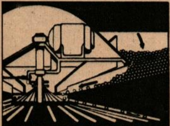
Le disséminateur de graines enrobées est fixé au fuselage de l'avion. Les canalisations tournantes répartissent les graines uniformément. Ci-dessous, la figure montre le mouvement des boulettes de la trémie vers les canalisations tournantes, au moyen de flèches indicatrices.
