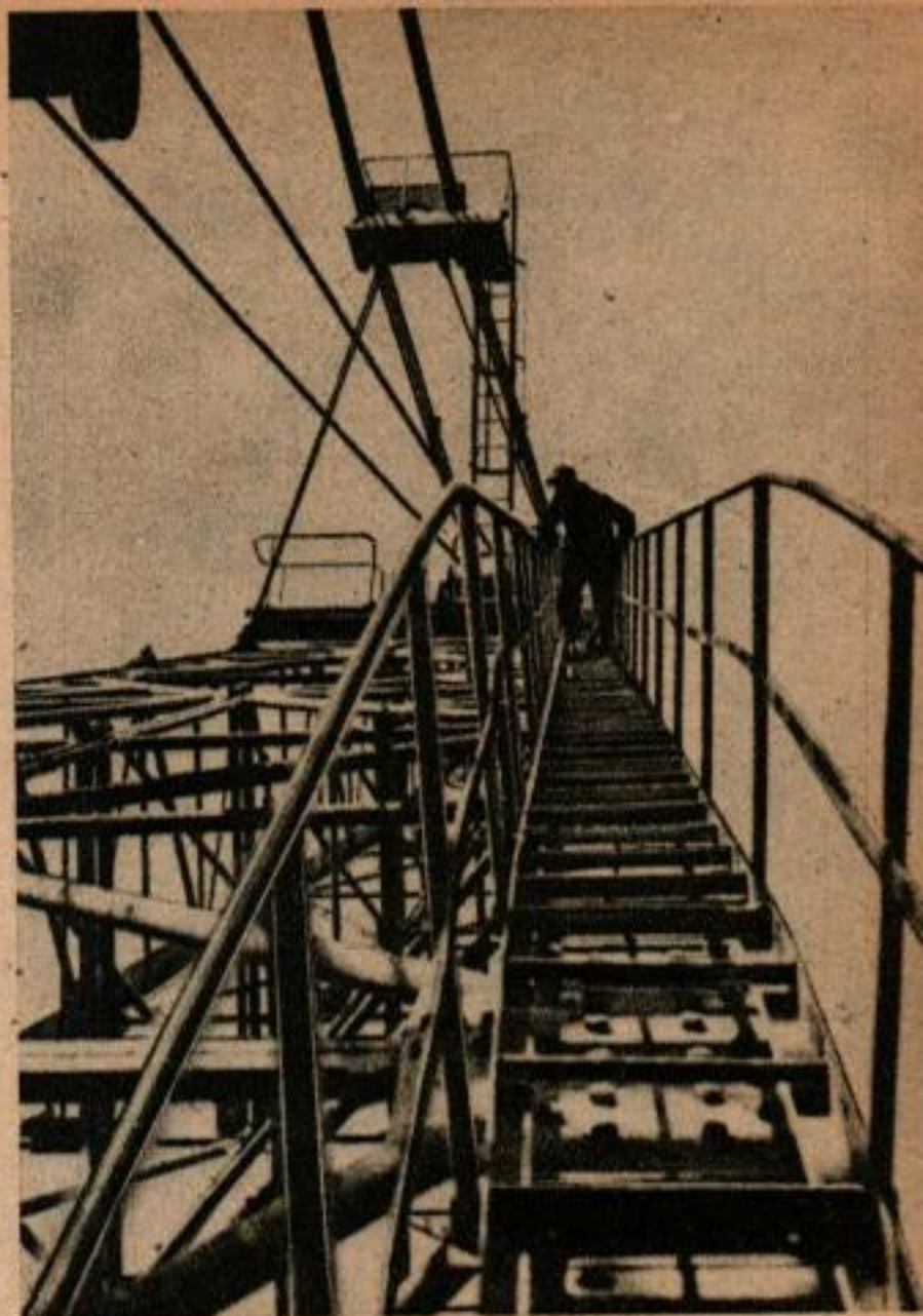
Galerie avec marches tout le long de la flèche pour permettre la surveillance et le graissage. En dessous, le mécanicien dispose de 2 leviers et de 2 pédales pour la manœuvre.
