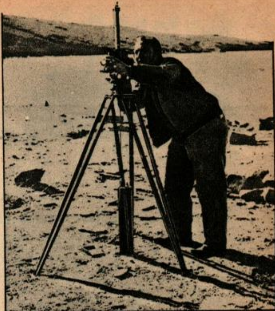
A 500 kilomètres au Nord du Cercle Arctique, un technicien mesure les variations magnétiques du compas.
