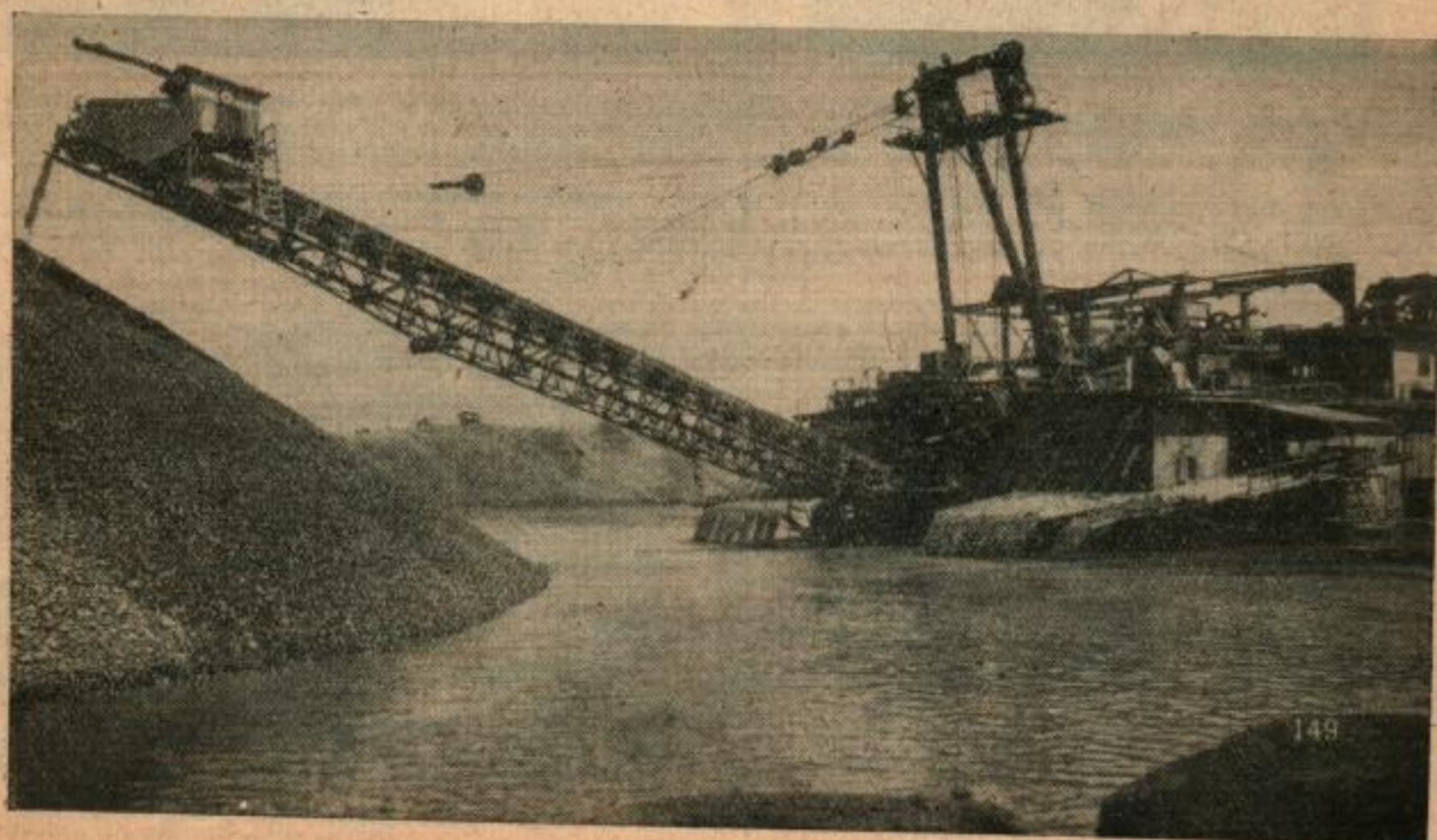
En haut, Des chariots sur monorail font la navette entre une mine de Death Valley jusqu'à la station de chargement. En bas, une drague de 0,420 mètre cube travaillant dans un placer.
