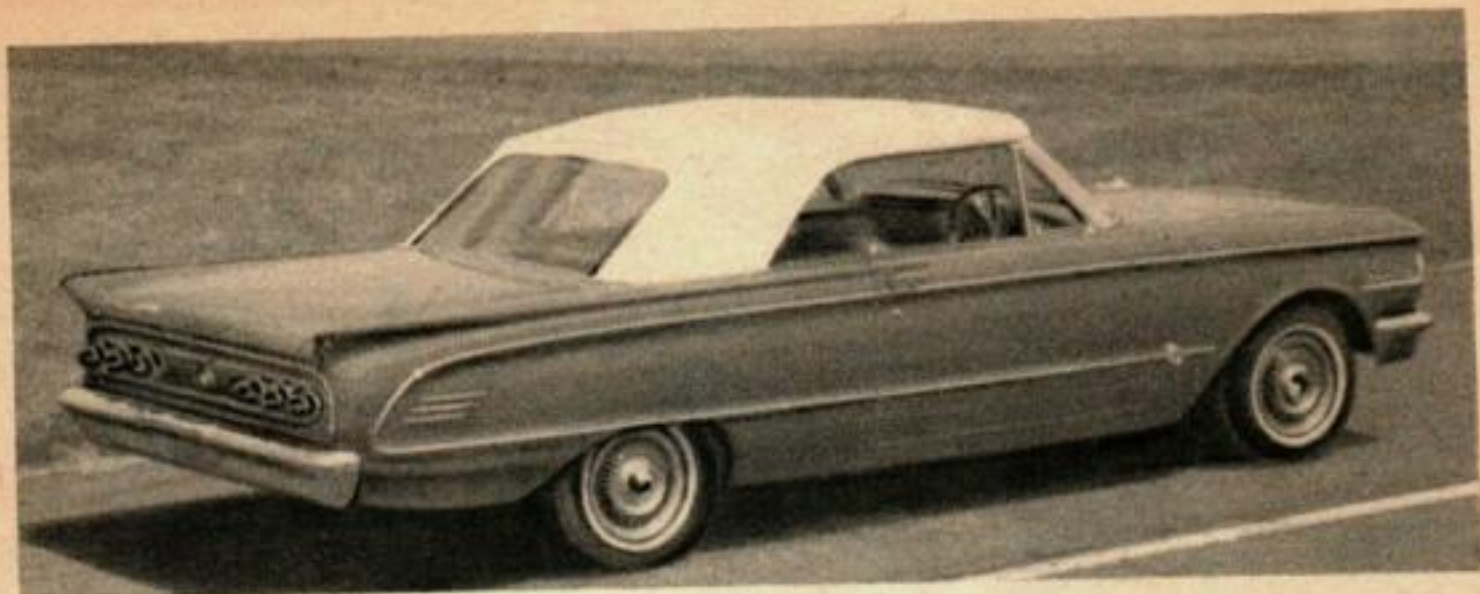
La Comet, comme sa compagne la compacte Falcon, devient décapotable en 1963. Sur 2,89 m d'empattement, elle aura un toit ouvrant à commande mécanique, des sièges avant type baquet, et la possibilité de choisir entre deux moteurs six cylindres : 85 ou 101 CV.
