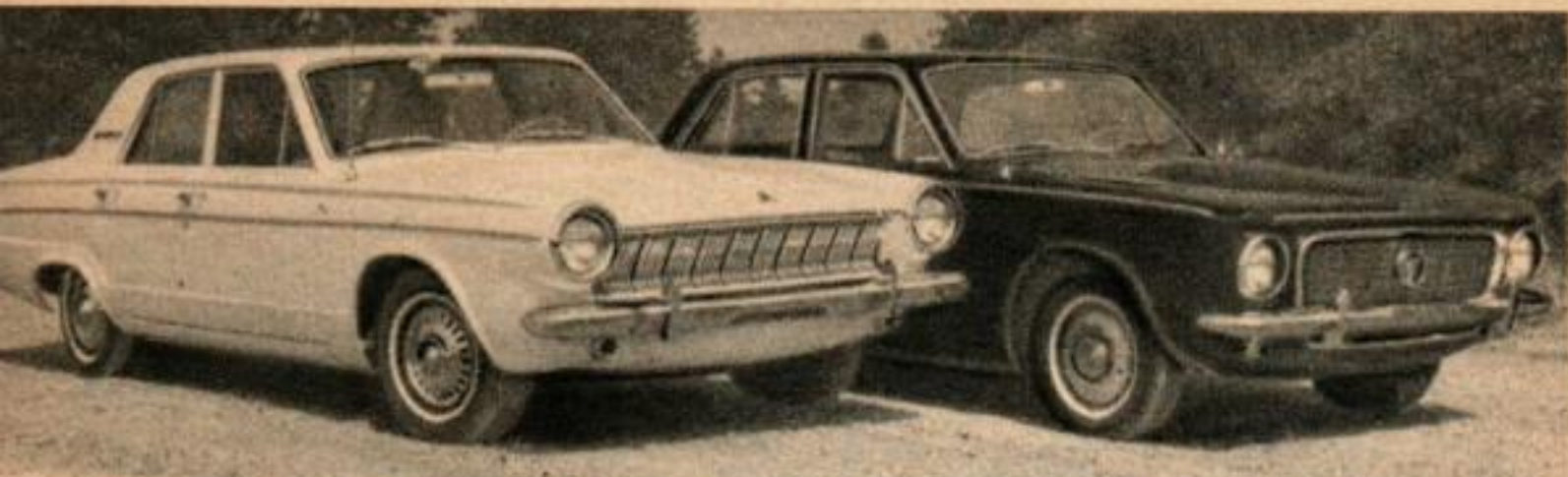
La Dodge Dart et la Valiant avaient le même aspect et la même taille en 1962. Pour 1963 (ci-dessus), elles partagent des moteurs six cylindres inclinés, le pare-brise, les suspensions et les transmissions, mais elles ont des carrosseries différentes. L'empattement de la Valiant est de 2,69 m ; celui de la Dart est de 2,82 m.
