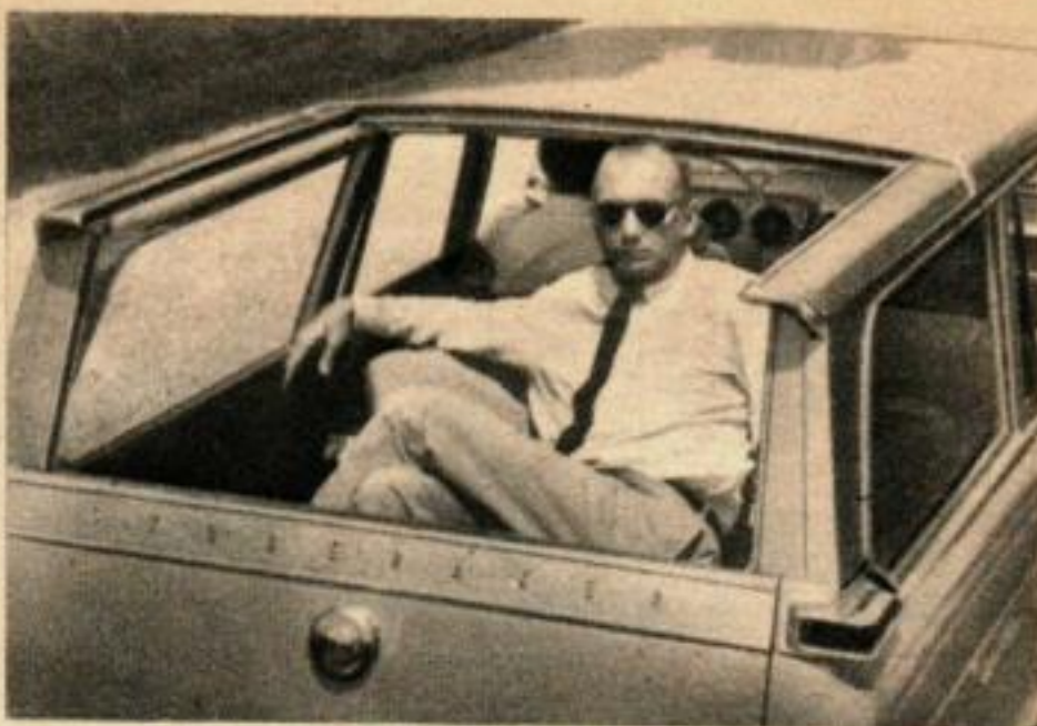
L'ingénieux toit coulissant de la Lark est de montage standard sur tous les stations-wagons ; il est appelé « Wagonaire ». Le panneau glisse vers l'arrière pour rencontrer la glace arrière.
