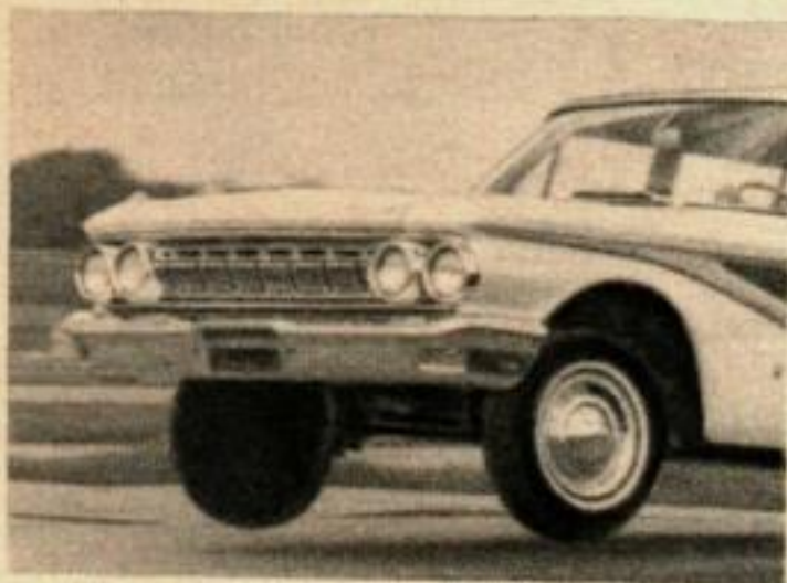
La Meteor prend les airs, mais l'extension à deux sens de sa suspension avant « élastique » aide à absorber le choc.
