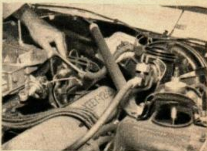
Ce dispositif à piston, monté sur la Meteor V-8, détecte l'augmentation de pression lorsqu'on utilise la servo-direction, et ouvre le papillon des gaz pour éviter que le moteur cale.
