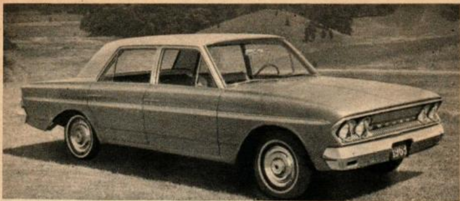
Les Rambler ont des carrosseries monocoques entièrement nouvelles pour 1963. Ci-dessus, la quatre portes Classic. Bien que l'empattement ait augmenté de 2,74 m à 2,84 m, la longueur totale a été réduite de plus de 25 mm. Les fenêtres sont incurvées.
