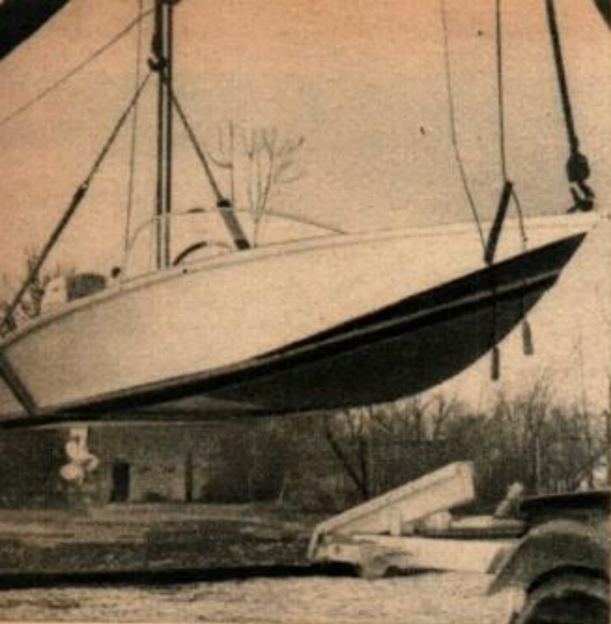
Suspendu au palan, le MP-38 montre les lignes de coque à glissement qui lui permettent d'atteindre de grandes vitesses avec un petit moteur.
