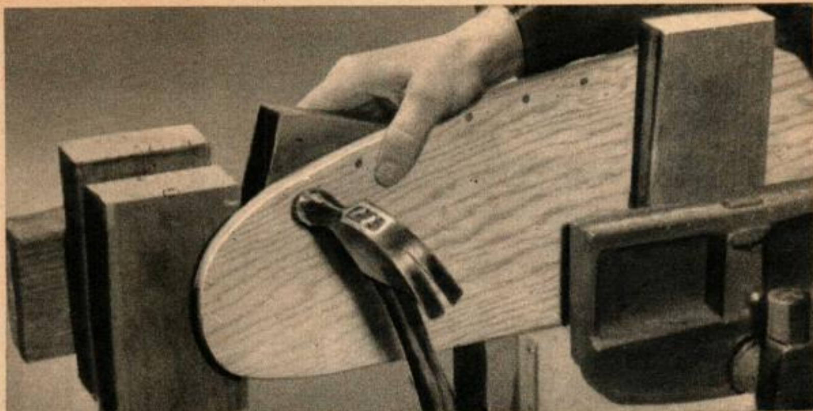
Le montage de courbage peut être fait de chevrons de 50 \times 100 mm et, lorsque le ski a été mis en place, le tout est serré dans l'étau de l'établi.
