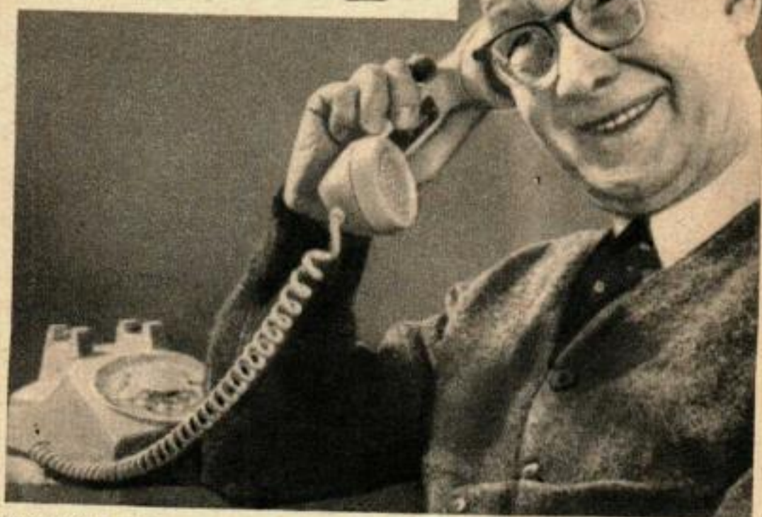
UN NOUVEAU RECEPTEUR TELEPHONIQUE à commande de réglage de volume s'adapte à tous les appareils téléphoniques modernes. Conçu pour les gens atteints de surdité partielle, le dispositif comporte dans la poignée une minuscule commande qui permet de régler le volume d'intensité des appels reçus au meilleur niveau d'écoute possible.
