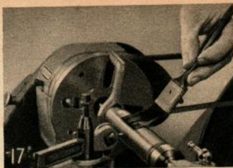
Utilisez toujours une huile de coupe, telle que de l'huile d'axonge, lorsque vous coupez des filetages. Appliquez-la au pinceau comme indiqué ici.
