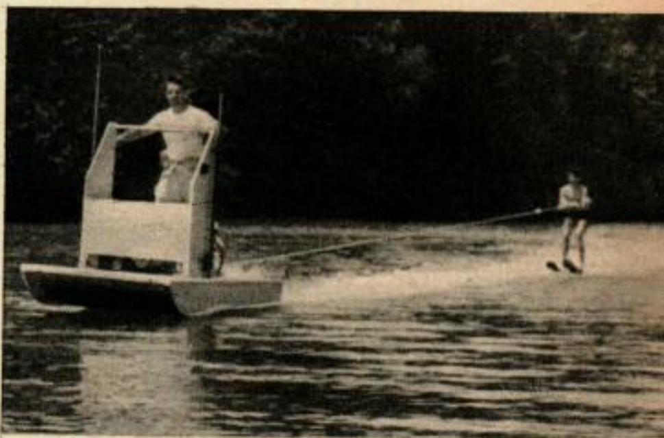
La coque en ponton est très rapide pour fonctionner en aquaplane. Avec un moteur de 15 HP, vous pouvez même utiliser l'embarcation pour le ski nautique.
