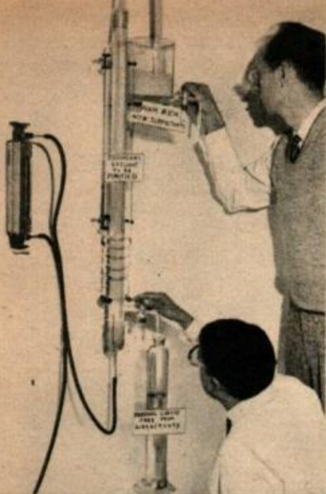
Le fractionnement de la mousse, une méthode d'élimination des déchets détersifs, est étudié dans les laboratoires Esso. De l'air est introduit dans des tubes (à gauche), et les bulles qui s'élèvent emportent les déchets chimiques jusqu'à la surface (à droite). La mousse est alors « écumée ».
