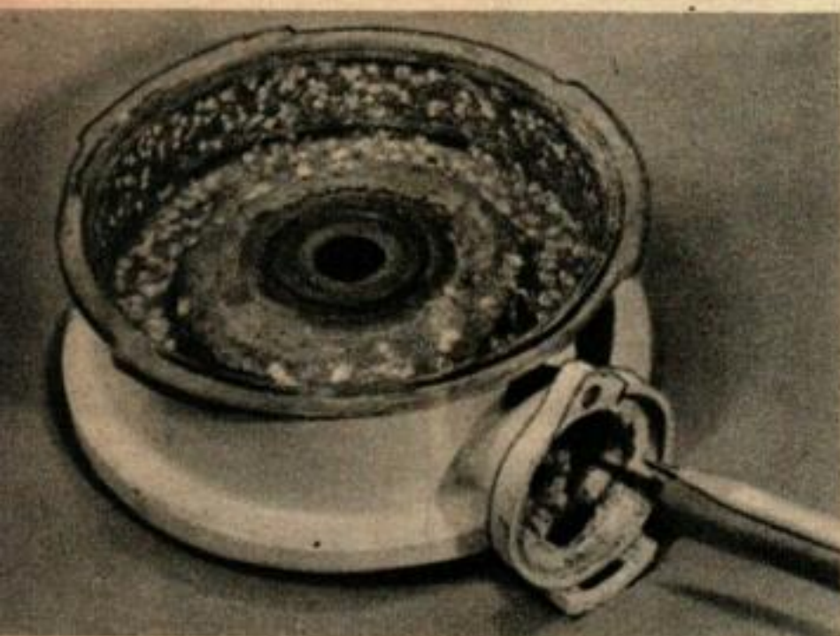
Cet appareil d'évacuation des ordures ménagères, monté comme filtre d'évier, montre les effets de la corrosion par les détersifs.
