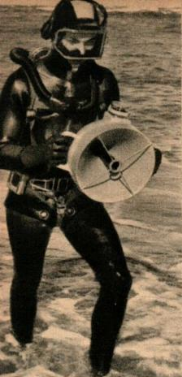
L'appareil Sonar (Sound Navigation Ranging = Repérage Navigationnel Sonique), que tient le plongeur, détecte les objets jusqu'à 110 mètres de distance. Le groupe autonome est équipé de deux jeux d'écouteurs, pour deux plongeurs ; il a un contact de réglage de portée à trois positions ; il résiste à la pression jusqu'à 60 mètres de profondeur.
