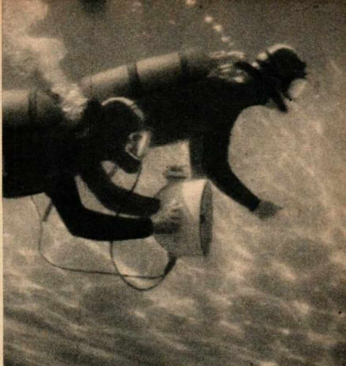
L'appareil Sonar (Sound Navigation Ranging = Repérage Navigationnel Sonique), que tient le plongeur, détecte les objets jusqu'à 110 mètres de distance. Le groupe autonome est équipé de deux jeux d'écouteurs, pour deux plongeurs ; il a un contact de réglage de portée à trois positions ; il résiste à la pression jusqu'à 60 mètres de profondeur.
