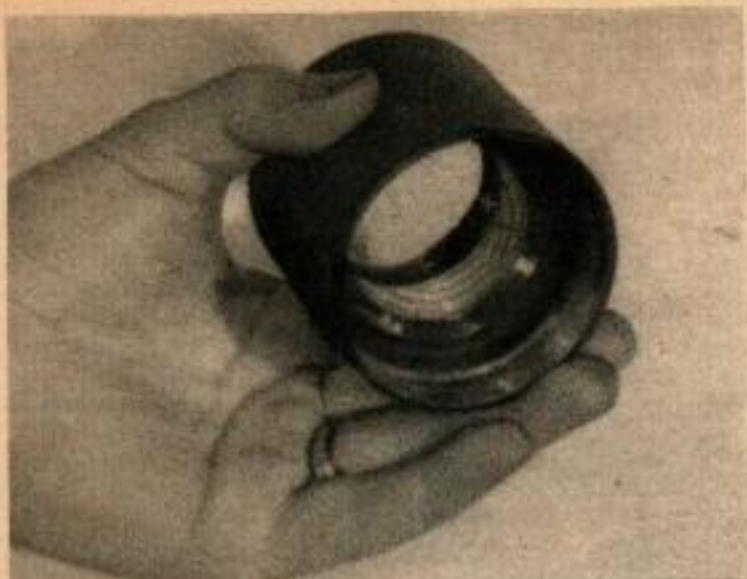
L'objectif Metrogon comporte un bon dispositif de correction pour l'aplatissement du champ de prise de vues sous un grand angle, et il convient parfaitement pour le projecteur.
