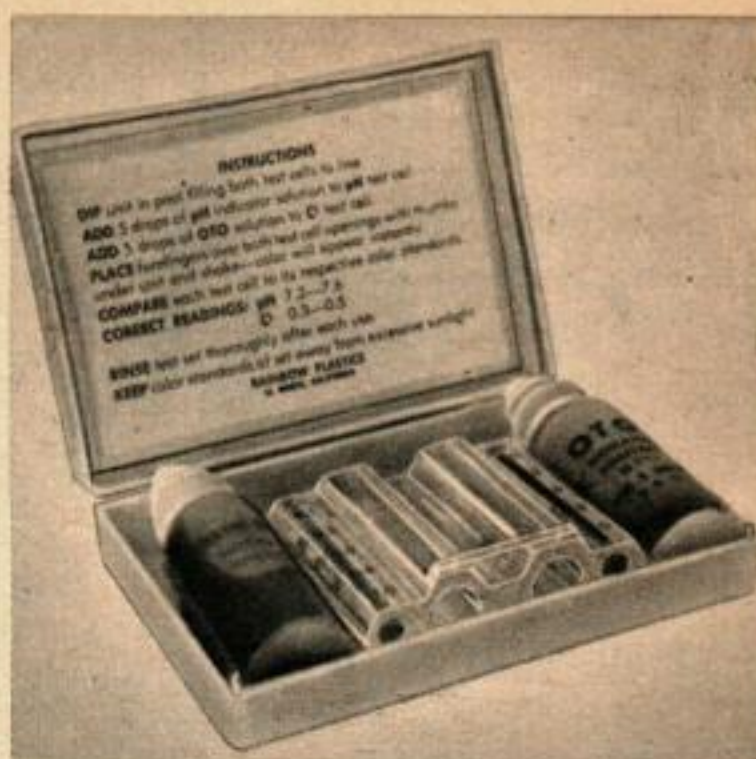
Ce simple nécessaire d'essai permet de vérifier la teneur en chlore et le coefficient pH par comparaison avec un tableau de couleurs; l'opération ne demande que deux minutes.
