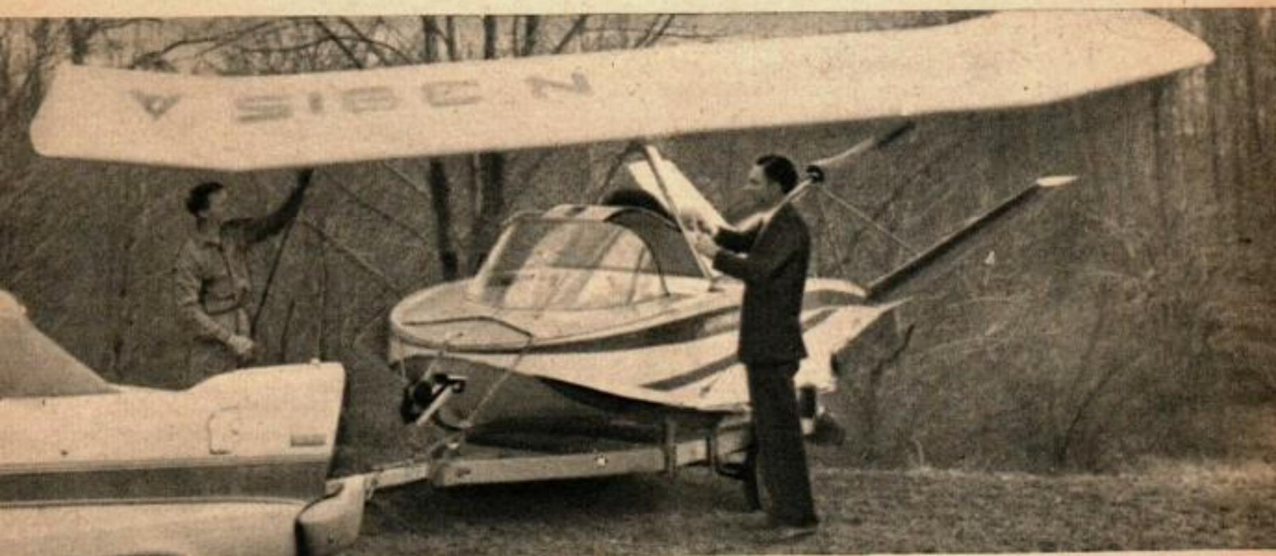
Au bord de l'eau, l'aile est aisément remise en place et fixée avec des câbles métalliques. Elle peut maintenant s'incliner dans les deux sens.
