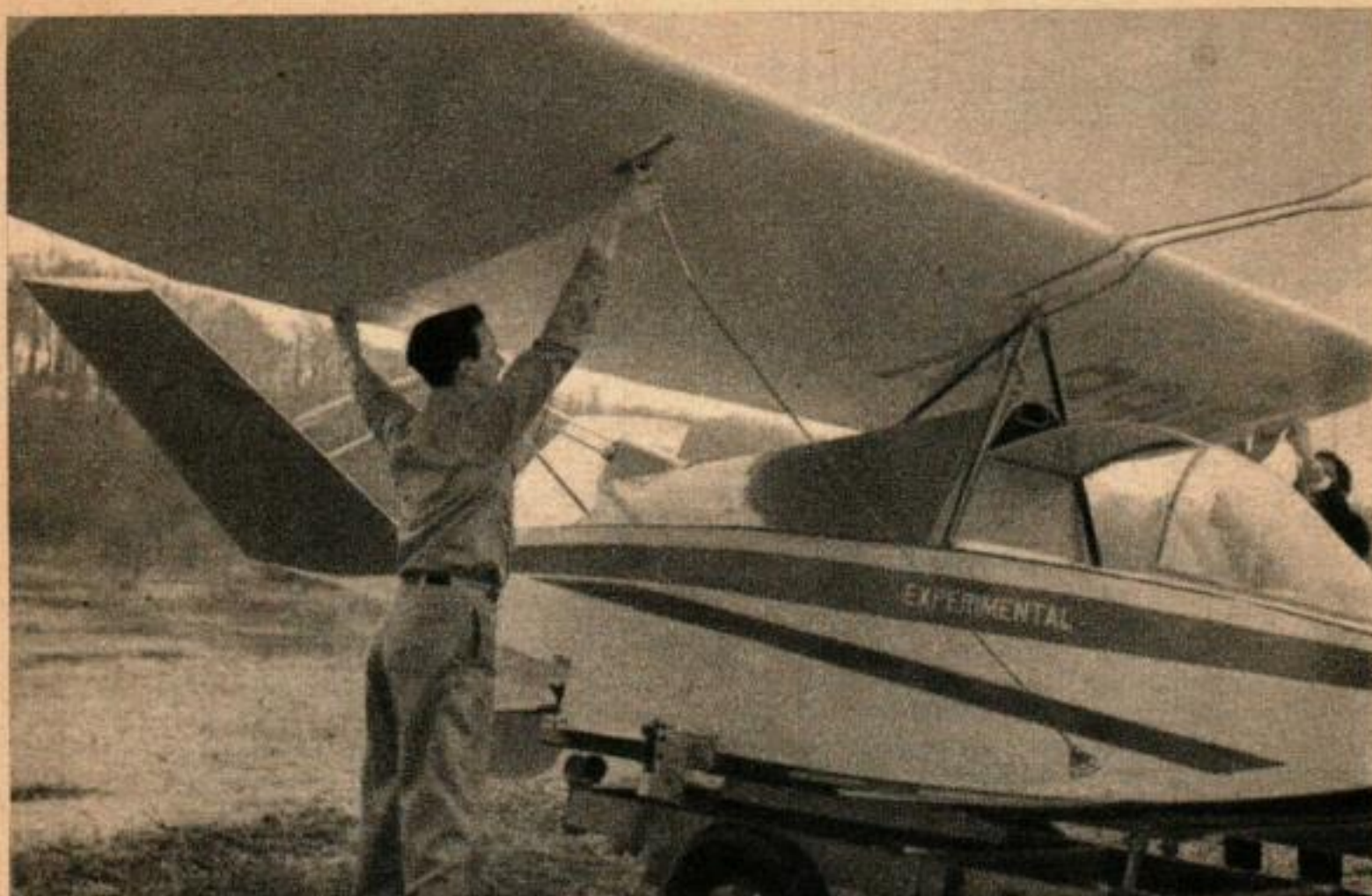
Des câbles métalliques tiennent l'aile en place pour le vol. L'aile est ancrée sur le pylône central qui se trouve derrière le cockpit. Sur les modèles de fabrication, les constructeurs ont l'intention d'éliminer les câbles et de faire commander l'aile entièrement à partir du pylône.
