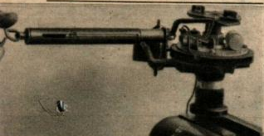
13. UNE TENSION CORRECTE du ressort de rupteur est nécessaire pour éviter le rebondissement des pointes de contact. Un peson (dynamomètre) à ressort permet une vérification de précision.
