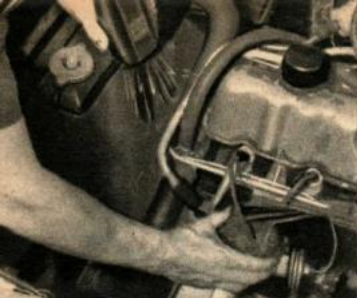
10. LA VERIFICATION DU CALAGE de l'allumage est l'essai final du système d'allumage. Un flash électronique « arrête » la marque sur le balancier harmonique par rapport à un index stationnaire.
