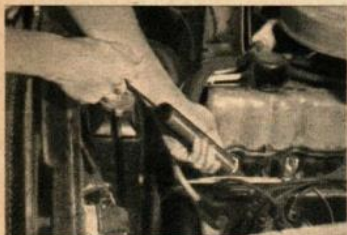
4. DESSERREZ LES BOUGIES, puis soufflez toutes les matières détachées qui peuvent se trouver dans les trous de bougie avant de finir de dévisser les bougies.
