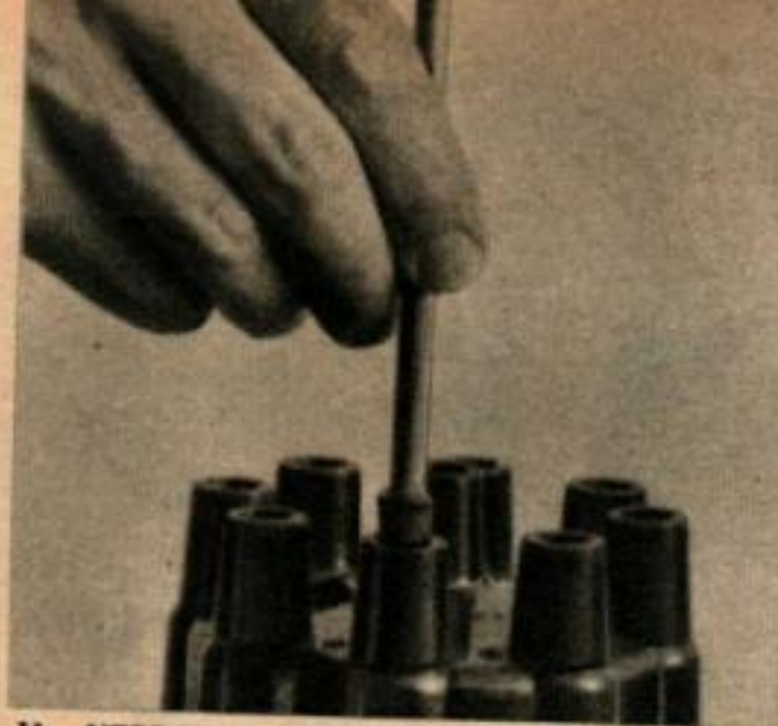
11. NETTOYEZ LES PORTE-FILS de bougie du distributeur avec une brosse spéciale à cet effet, ou avec du papier de verre enroulé sur une baguette ronde.
