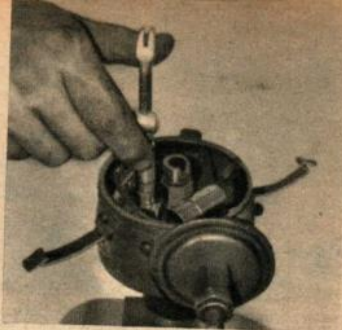
12. LE REGLAGE DE LA TENSION du ressort de bras de rupteur s'effectue avec un outil spécial. Celui-ci maintient les pointes de contact à l'alignement.
