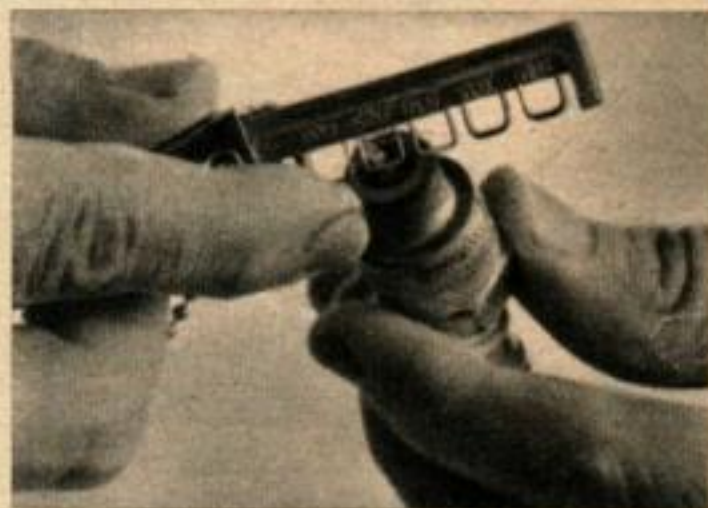
7. CETTE JAUGE D'ECARTEMENT du type à fils métalliques est peu coûteuse et sert, en même temps, de lime à électrodes. Elle permet d'effectuer un travail de réglage d'écartement des électrodes très précis sur toutes les bougies de tailles communes.
