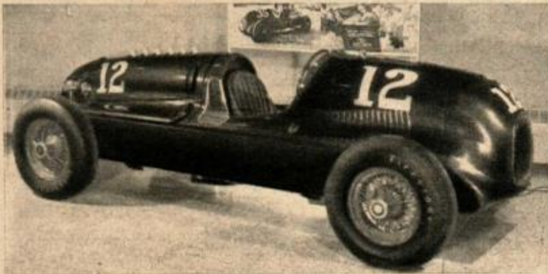
1938. — L'écurie de ces voitures à moteur arrière et transmission sur les quatre roues eut de nombreux malheurs, et cette idée n'a pas été reprise depuis lors.
