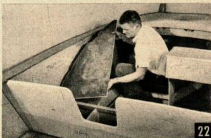
Les panneaux de plancher avant doivent être découpés de façon à épouser la courbe de la coque, mais ils ne doivent pas entrer en contact avec le revêtement.
