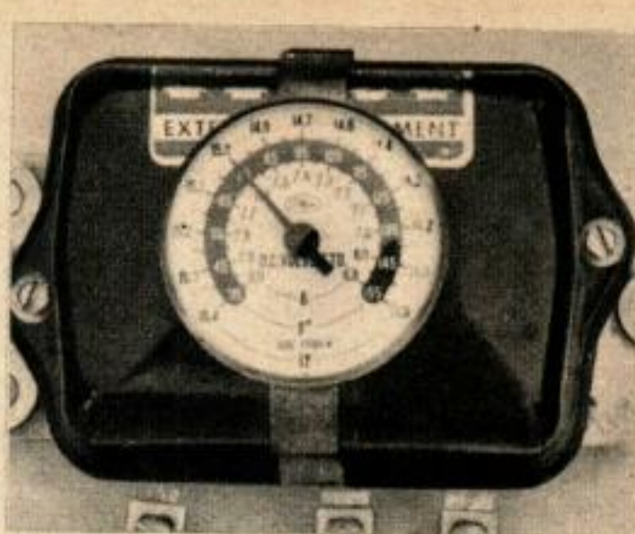
4. LE THERMOMETRE de régulateur indique la température et le réglage moyen du limiteur de voltage, ou régulateur.
