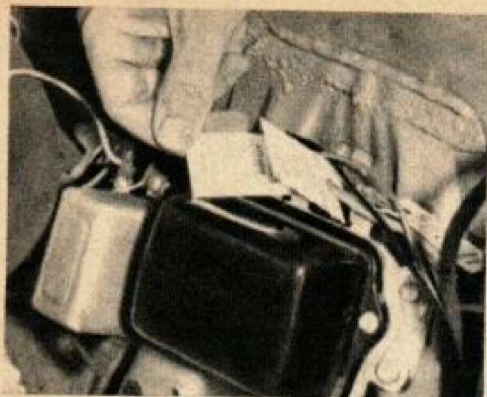
3. AVANT DE PASSER aux essais, étiquetez tout fil devant être détaché de sa borne. Un rebranchement incorrect pourrait provoquer des dommages.
