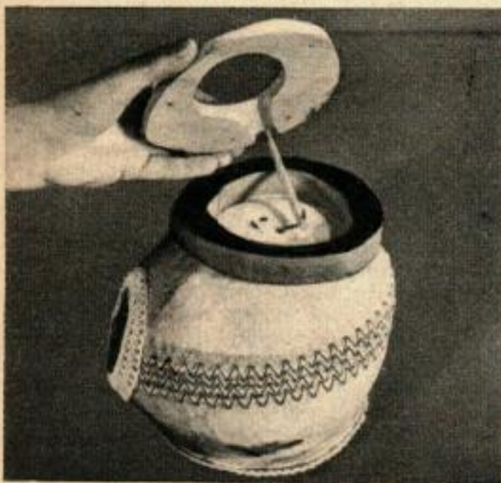
La baguette de manivelle a un trou percé dans l'un de ses bouts, pour tenir l'extrémité pliée de l'axe en fil métallique qui actionne le disque.
