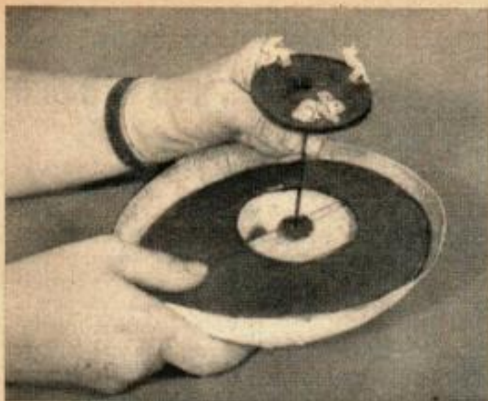
Le disque rotatif est connecté à la baguette de manivelle par un gros fil métallique qui passe à travers le support.
