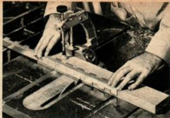
Les cornières d'aluminium qui tiennent les sections du balai en place sont encochées sur le plateau de la scie circulaire. Remarquez la barre de bois de support.
